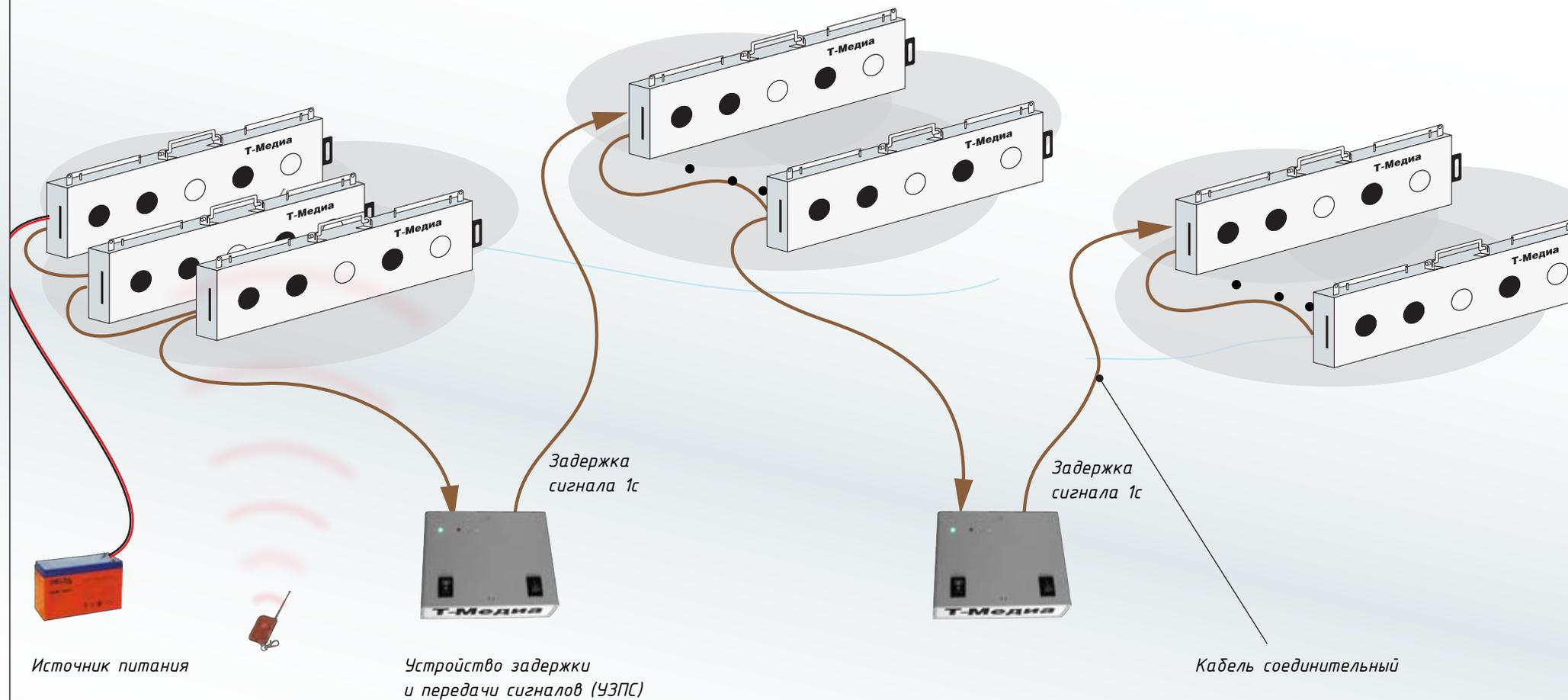
Схема подключения с использованием Устройства задержки и передачи сигналов
