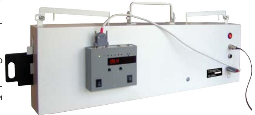
Блок индикации и управления, установленный на мишенном модуле
