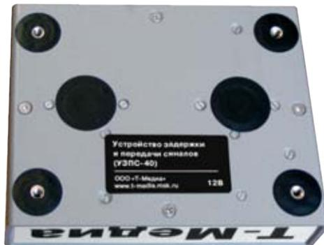
УЗПС крепится к стене или к корпусу мишенного модуля при помощи встроенных в его корпус магнитов
