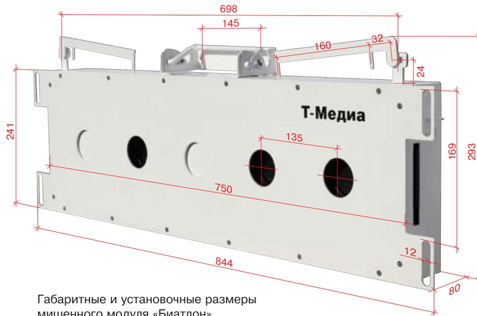
Габаритные и установочные размеры мишенного модуля «Биатлон»
