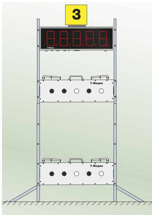
Секундомер автоматически стартует при открывании мишеней, после поражения последней мишени останавливается
