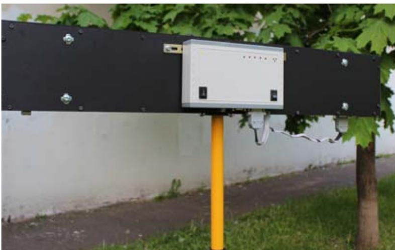
Модуль радиоприема и питания МРП-5К, установленный на Световом табло ТС-2
