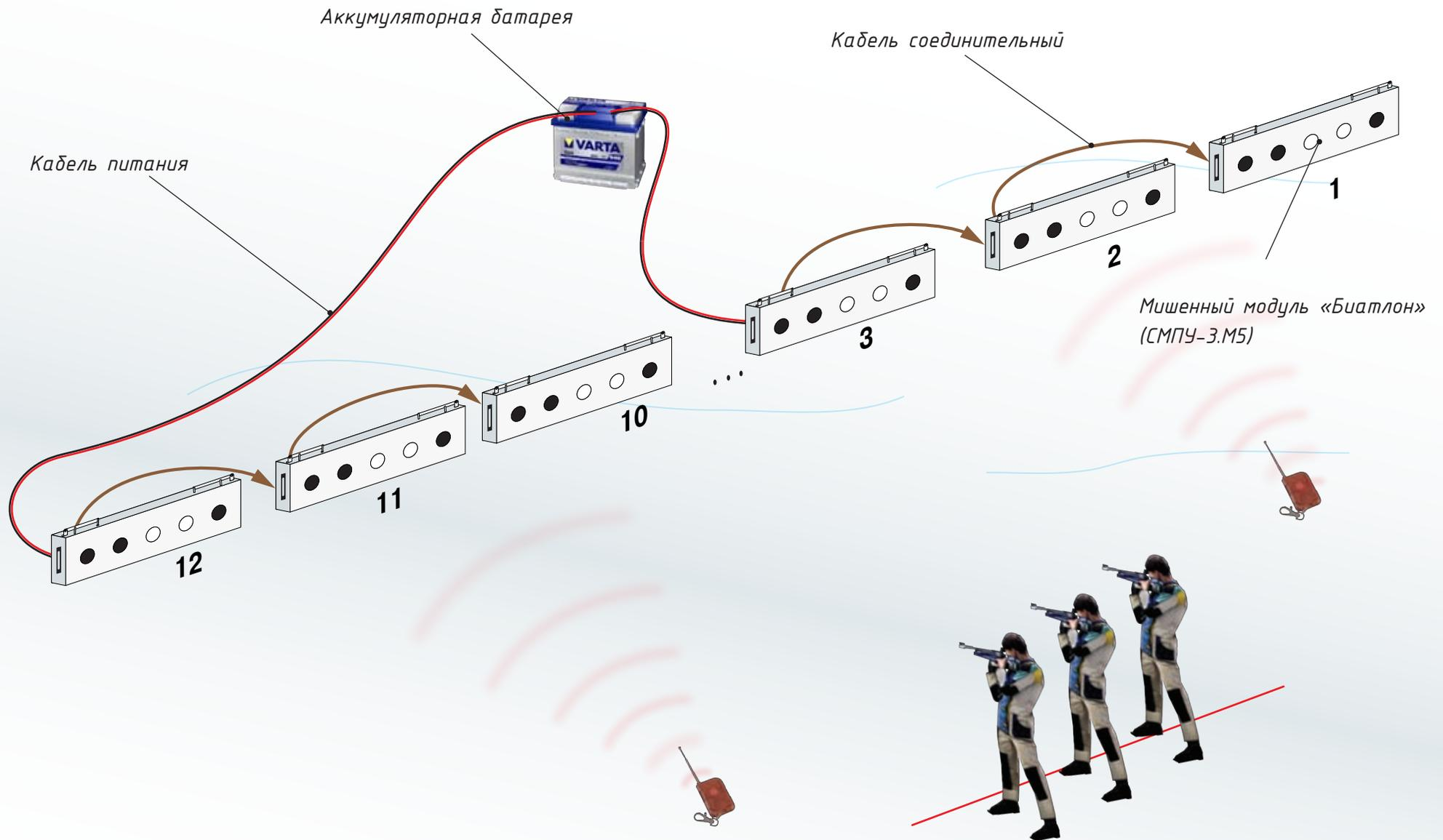
Несколько мишенных модулей «Биатлон» объединены в группы по 3шт. при помощи соединительного кабеля. Открытие мишеней каждого модуля производится с помощью одного (любого из группы) пульта дистанционного управления.
