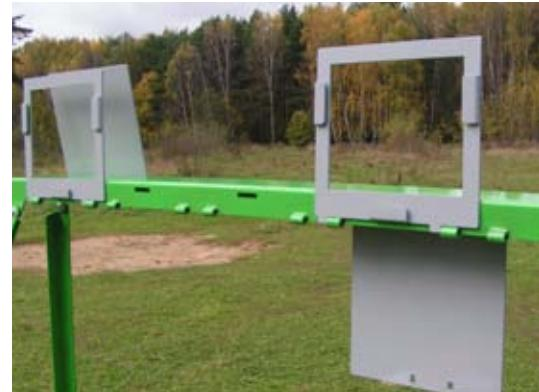
Пулеулавливатели ПУ-1, ПУ-2 предназначены для предотвращения разлета пуль и их осколков при стрельбе. Изготавливается из конструкционной стали толщиной 3 мм. Пулеулавливатель ПУ-2 отличается от пулеулавливателя ПУ-1 увеличенным расстоянием от зацепа, удерживающего пулеулавливатель в наклонном положении до плоскости пластины, что позволяет организовывать сплошную защитную зону размером 1070 мм x 210 мм.
