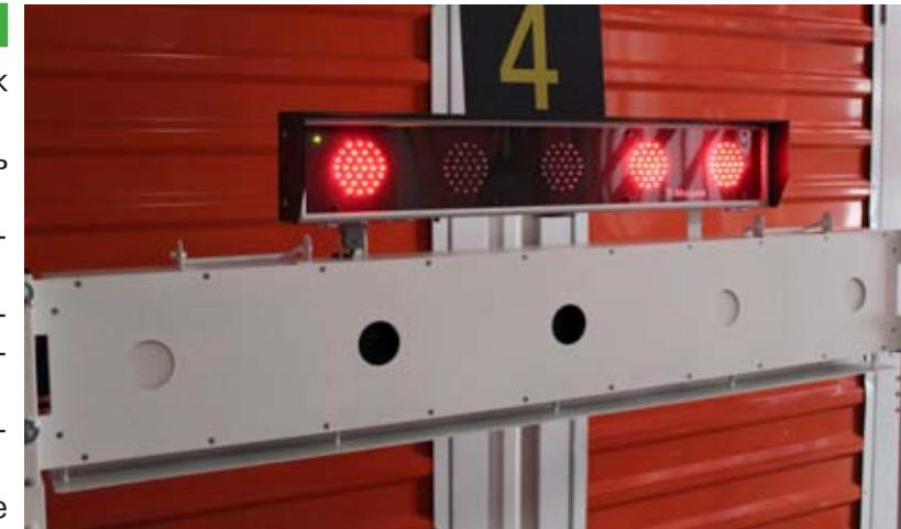
Мишенная установка для скоростной стрельбы на Стойке биатлонной СБ-1
