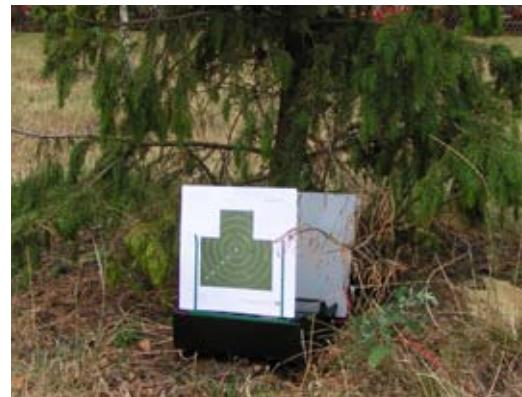
Питание установки осуществляется безопасным напряжением 12В постоянного тока (аккумуляторная батарея или сетевой адаптер). Несколько мишенных установок можно объединять в группу и использовать при этом один источник питания.
