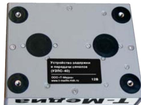
УЗПС крепится к стене или к корпусу мишеннного модуля при помощи встроенных в его корпус магнитов
