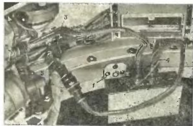
Рис. 63. Установка ПУСОГ в башне БМП:
