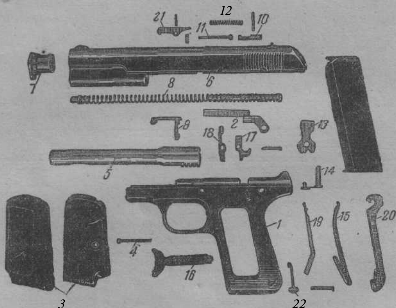
Фиг. 251. Пистолет Браунинга обр. 1903 г. разобранный.
