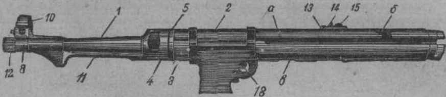
Фиг. 396. Остов пистолета-пулемета собранный.
