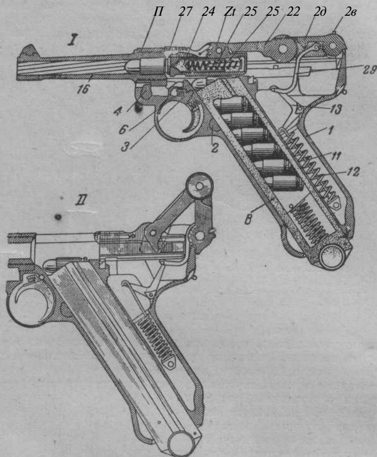
Фиг. 287. Разрез пистолета по оси.
