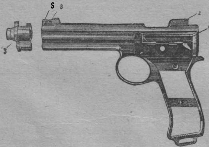
Фиг. 298. Рамка и муфта ствола.
