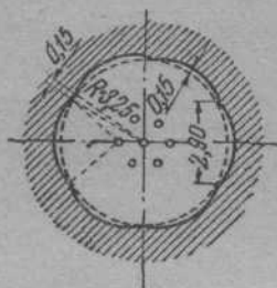
Фиг. 73. Нарезы 6,5-лш винтовки системы Арисака.
