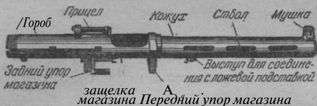
Фиг. 347. Короб-кожух со стволом и прицелом.
