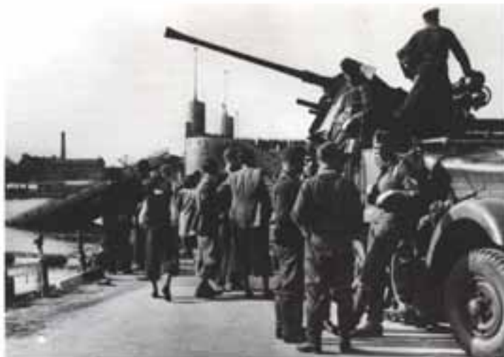
Зенитная самоходная установка 37-мм автоматической пушки FlaK 36 на базе полугусеничного тягача Sd.Kfz. 6/2 на берегу р. Маас, Бельгия, май 1940 года
