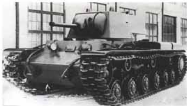
Первые 139 танков KV-1 также были вооружены 76-мм пушками Д-11
