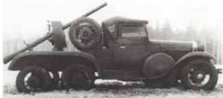
Самодвижная пушка Курчевского (СПК) — 76-мм динамометрическая (безоткатная) пушка, установленная на автомобиле ГАЗ-ТК. К началу 1941 года в войсках имелось около 20 СПК, большая часть из которых была неисправна
