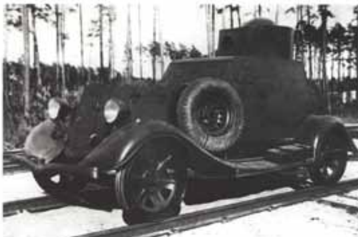
Броневые автомобили-драйзинги БА-20жд входили в штат бронепоездов Красной Армии
