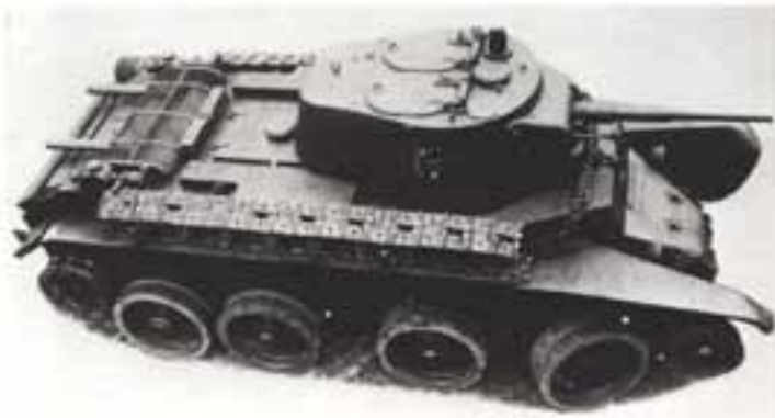
Легкий танк BT-7M на колесном ходу. От карбюраторной «семерки» этот танк можно было отличить только по отсутствию «летяжки» воздушного очистителя на крыше МТО
