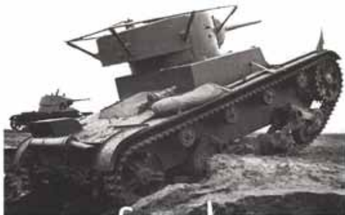
Наиболее многочисленной модификацией Т-26 была машина образца 1933 года — с цилиндрической башней. На фото, так называемый, радиный танк, то есть оснащенный радиостанцией ТТ-ТК-3. Радионую машину можно было легко опознать по поручневой антенне на башне
