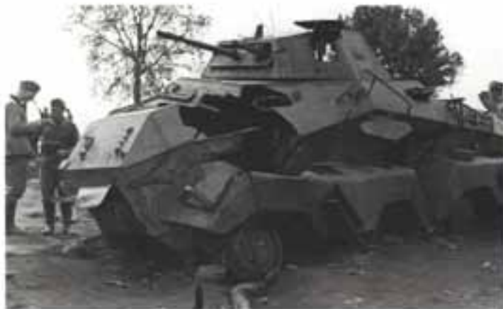
Бронетанкобиль Sd.Kfz.231 (S-Pak), уничтоженный по- падением крупнока- либерного снаряда (по-видимому 75 мм) польской артилле- рии. Сентябрь 1939 года
