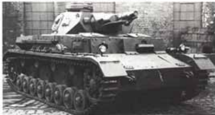
Главным отличием Рt.IV Aml.E стало существенное увеличение толщины брони. Ее довели до 30 мм и усилили 30-мм экраном. С сентября 1940 по апрель 1941 года заводское цеха показало 223 машины варианта E
