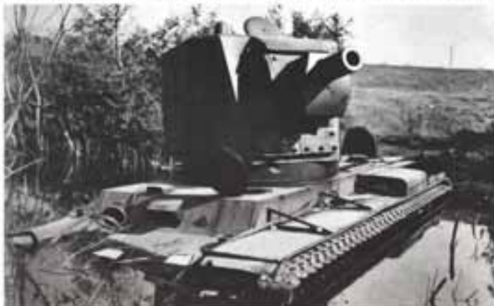
Застывший в болоте, и подорванный захваченный KV-2 с башней МТ-1. Северо-Западный фронт, 2-я танковая дивизия, июнь 1941 года
