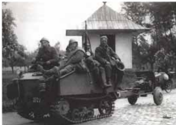
Трактор Utility В одного из противотанковых подразделений бельгийской армии буксирует 47-мм противотанковую пушку FRC mod. 1932. Май 1940 года
