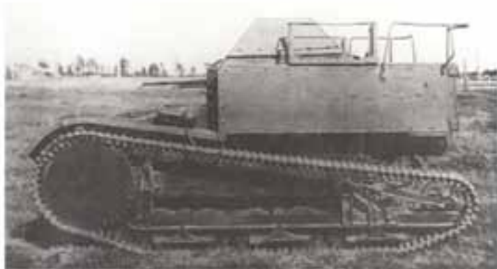
Нехватка тягачей «Комсомолец» заставляла использовать для буксировки легких артиллерийских орудий соответствующие образцы танкетки Т-27 (фото слева и внизу)
