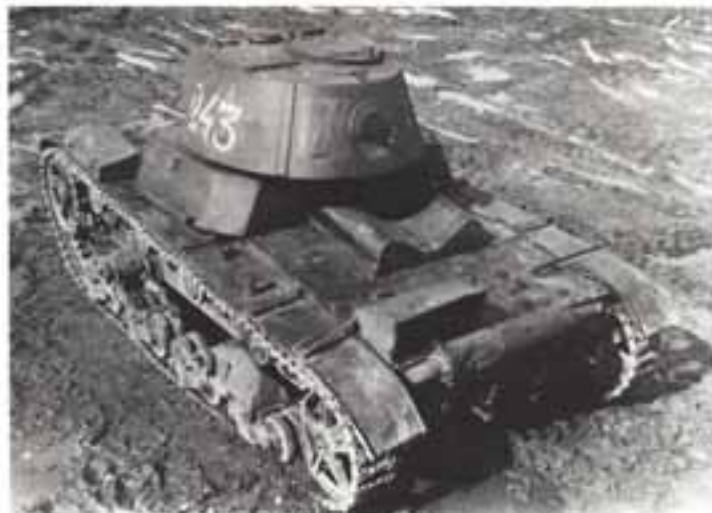
Наиболее совершенной модификацией были машины образца 1939 года — с конической башней и наклонной броней подбашенной коробки
