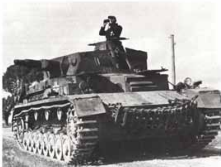
Рt.IV Aml.D, 6-я танковая дивизия, лето 1941 года. К началу операции «Барбаросса» машины раннего выпуска приобрели черты, характерные для более поздних моделей, например, гусеничные траки на лобовом листе корпуса
