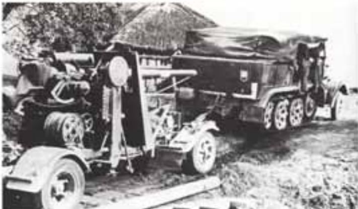
Полугусеничный тягач Sd.Kfz. 7 буксирует 88-мм зенитную пушку FlaK18. Это орудие поставлено находилось в боевых порядках танковых частей Вермахта
