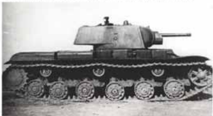
С 1941 года танки KV-1 начали выпу- скаться с 76-мм пуш- кой Ф-32. До начала войны Кировский завод выпустил 423 танка с обоним типом пушек
