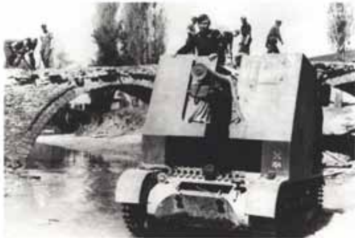
150-мм самоходное орудие sG33 из состава 704-й роты самходных тяжелых пехотных орудий. Гречия, апрель 1941 года
