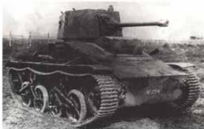
Легкий танк «Виккерс» с 40-мм пушкой. Несмотря на то, что достигая таких же скоростей, как и с пулеметным вооружением, доставляемое в наследство от армии Латвии и Литвы можно было считать относительно боееспособным
