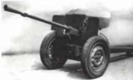
Французская 25-мм противотанковая пушка «Гочкис» мод. 1934
