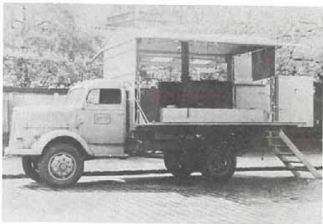
Трехтонка «Опель-Блиц» S в качестве пожарного автомобиля с мотонасосным агрегатом KS 15 (кузов фирмы «Магнус»), поставлявшийся в военно-воздушные силы в апреле 1941 г.
