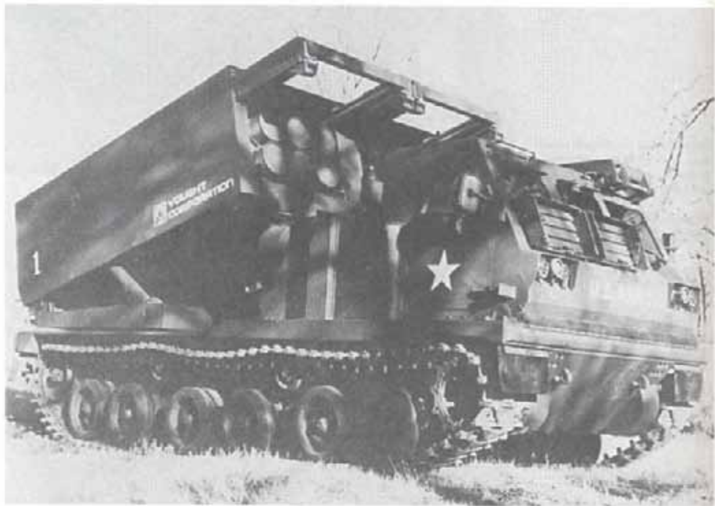
Самоходная ракетная система MARC. Многозарядная ракетная установка, дальность стрельбы 30 км
