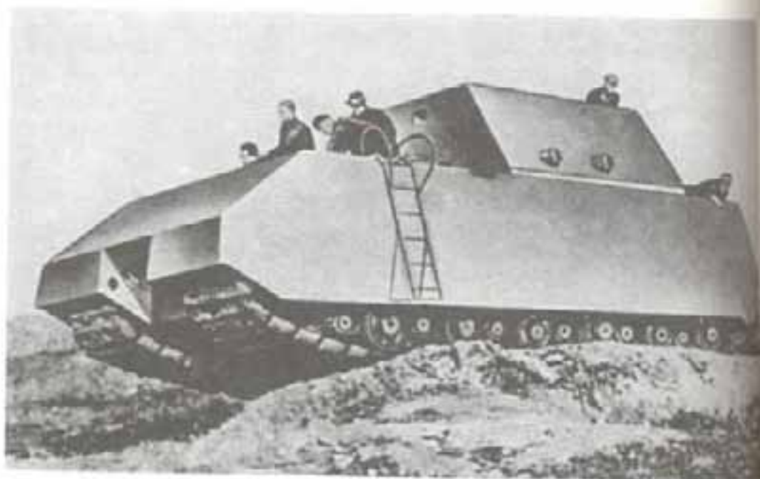
Прототип разрабо- танного профессором Порше 200-тонного танка «Маус»
