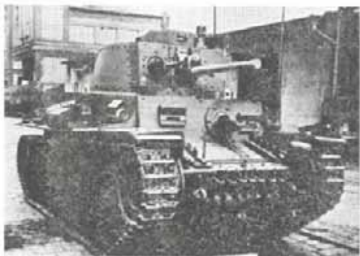
Танк Pz 38 (t). Новая машина для вермахта, впереди слева на машине видна фара со слетомаскировочным устройством.
