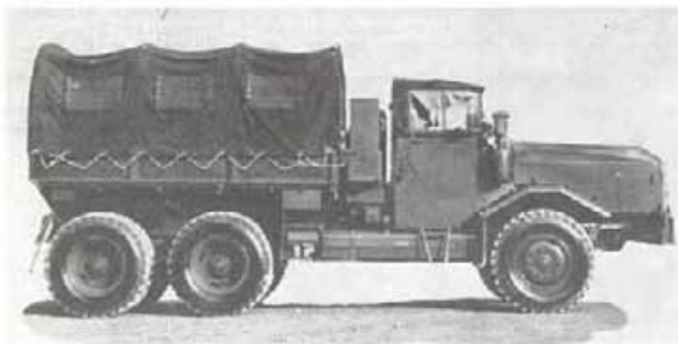
«Фаун» L 912/45 A был тяжелым грузовым автомобилем на 15 т груза, оснащенным дизелем V 12 системы «Дойц».
