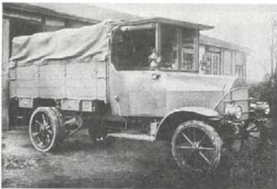
Армейский грузовой автомобиль «Магирус» тип 3К с цепной передачей, полезная нагрузка 3 т, 1917 г.
