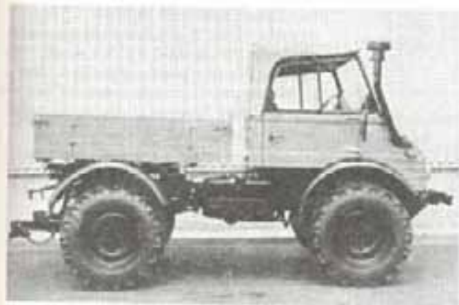
Фото сверху слева: легкий тягач «Мерседес-Бенц Унимог» U 600. Дизельный двигатель 62 л. с., 5-ступенчатая коробка передач, полный привод, вес 2650 кг.
