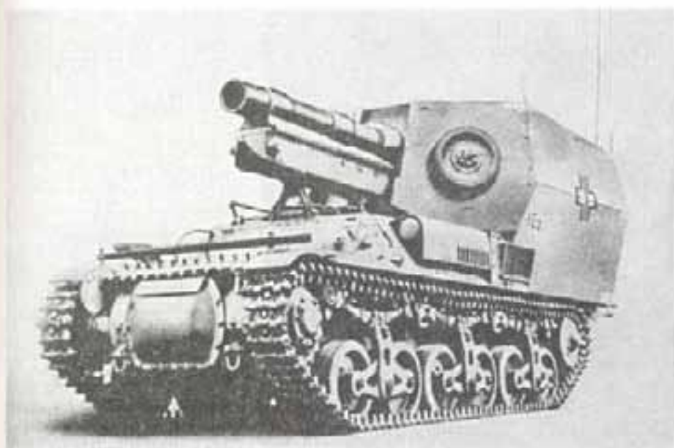
150-мм тяжелая полевая гаубица 13 на гусеничном шасси тягача «Лоррен» (Франция)
