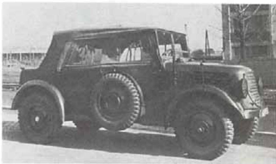
Предприятие «Шкода» с 1941 по 1943 г. поставляло автомобиль «Супер б 3000» (Super b 3000) в качестве кобелявагена Kfz. 15 для нужд вермахта. Предположительно эта машина предназначалась для использования в войсках наших союзников.
