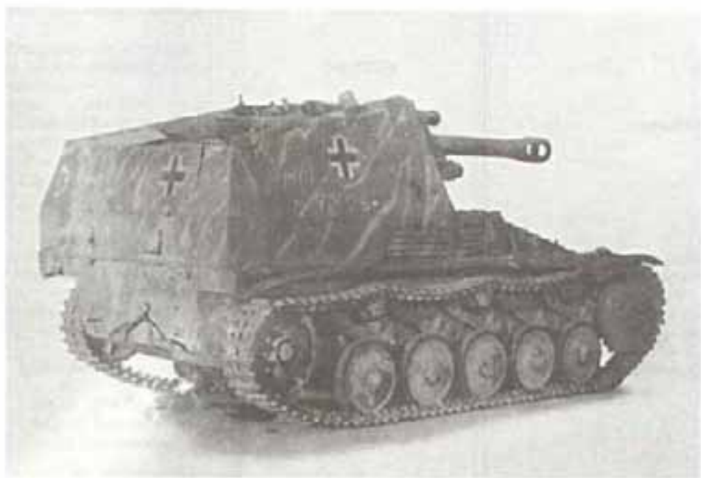
«Besene» — 105-мм легкая полевая гаубица на шасси танка Pz II
