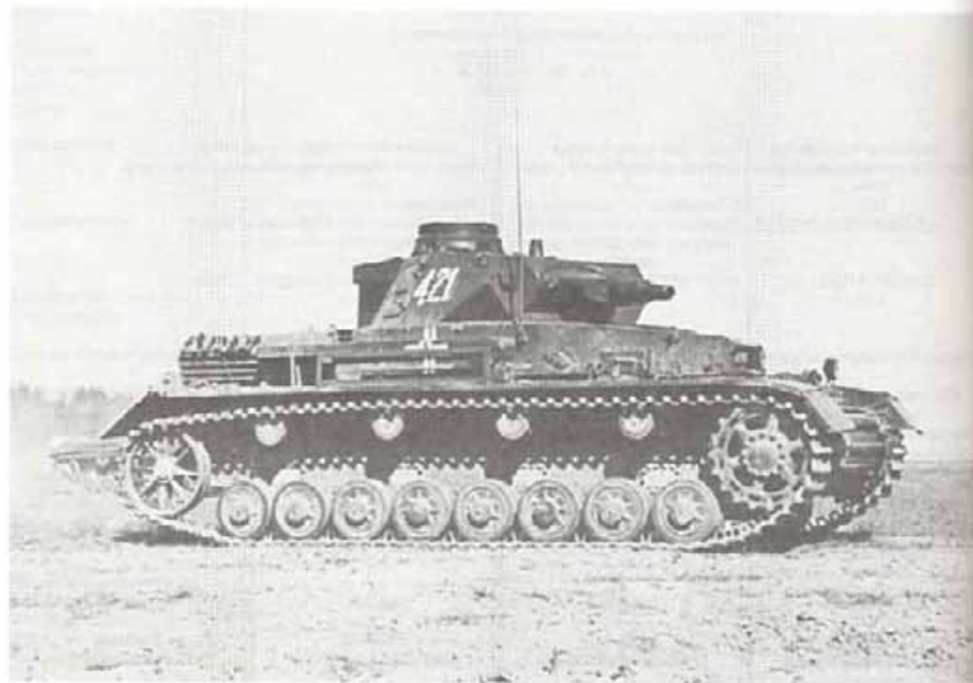
Танк Pz IV B с короткой пушкой калибра 75 мм
