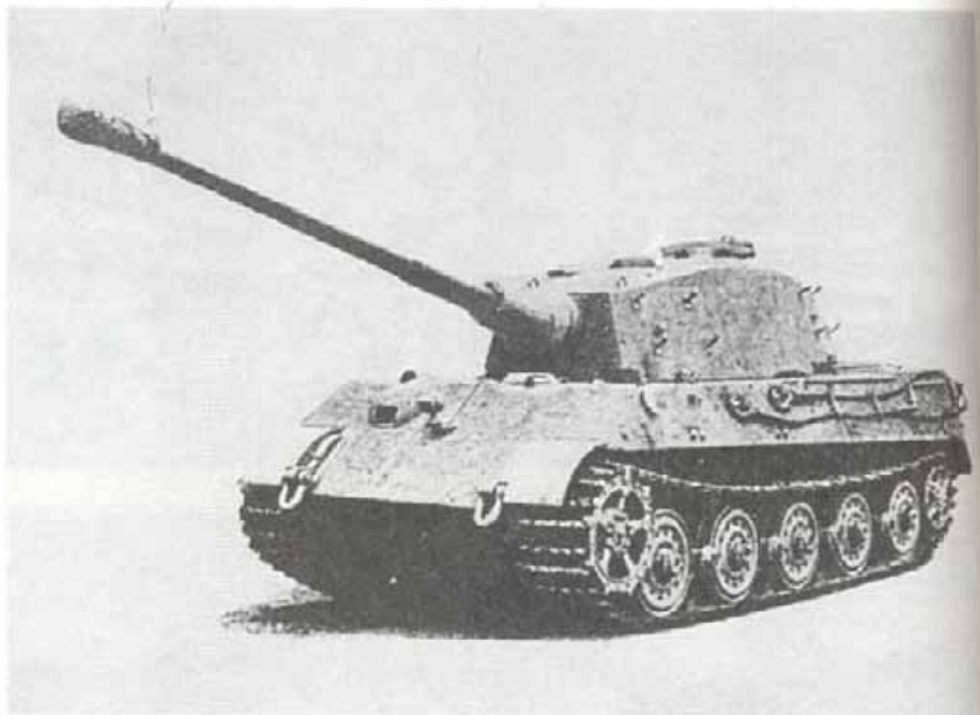
Танк «Королевский Тигр» («Тигр II» модификации В) с орудием KwK 43 L/71 и с башней производства фирмы «Хеншоль».
