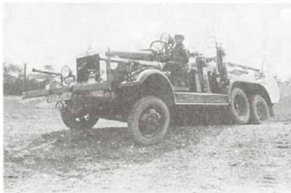
Первый германский аэродромный пожарный автомобиль: «Магирус» М 206 (с дизелем) в качестве автомобиля-топливозаправщика. Транспортно-летная школа в Нойглузене.
