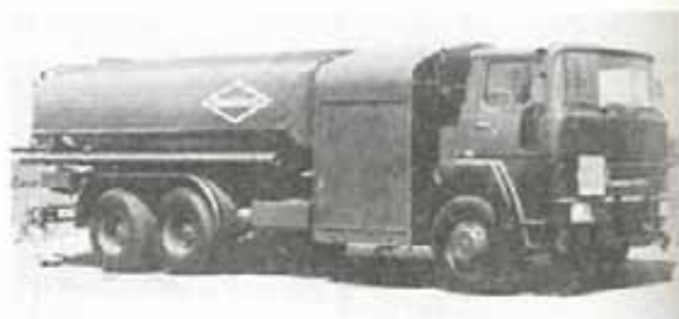
Аэродромная автоцистерна 15 000 л «Магirus» 6 x 4
