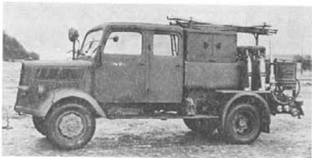
Трехтонка «Опель-Блиц» TD 1,5 (кузов фирмы «Магнус») в качестве пожарного автомобиля-цистерны, поставлявшийся в военно-воздушные силы в апреле 1943 г.
