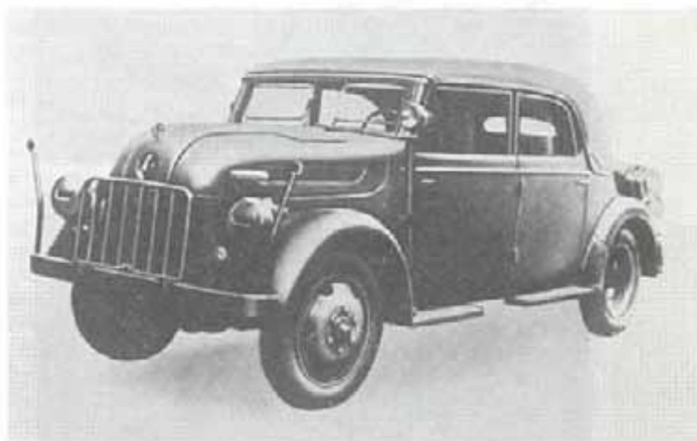
Модель «Феномен Гранит» 1500 А, командный автомобиль с «тропическими» шинами (внедорожный протектор), 1942–1943 гг.
