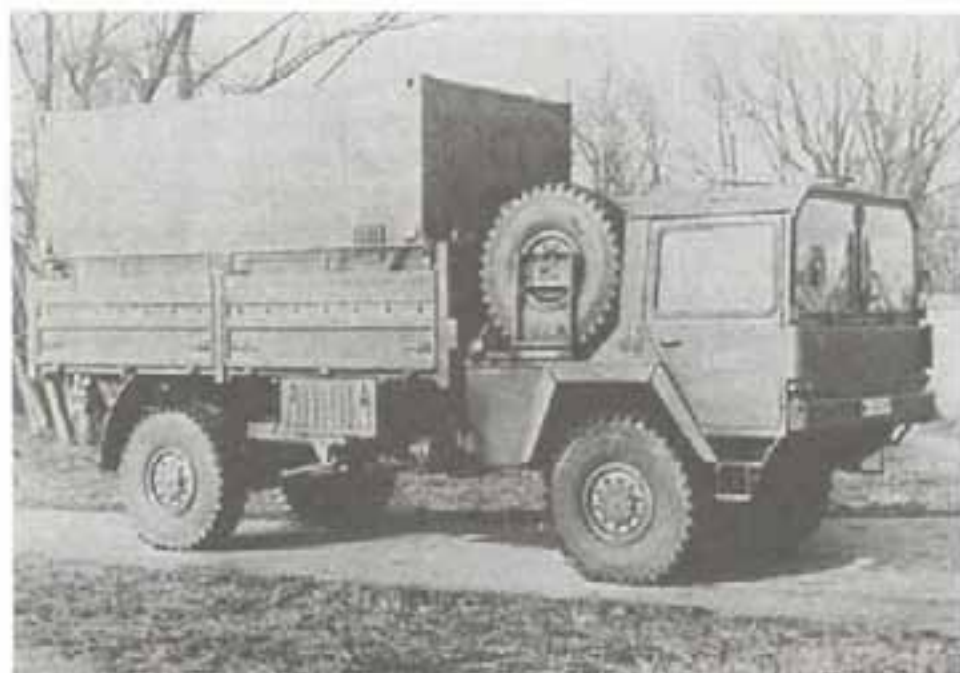
Грузовой автомобиль повышенной проходимости 5 т (4 х 4) MAN N 4510 с бортовой платформой с 1977 г.
