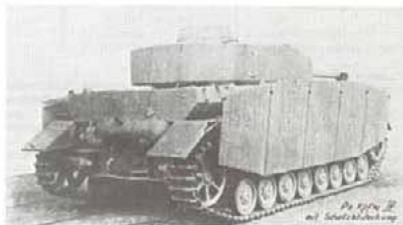
Танк Pz IVH с длиной 75-мм пушкой и с экранами
