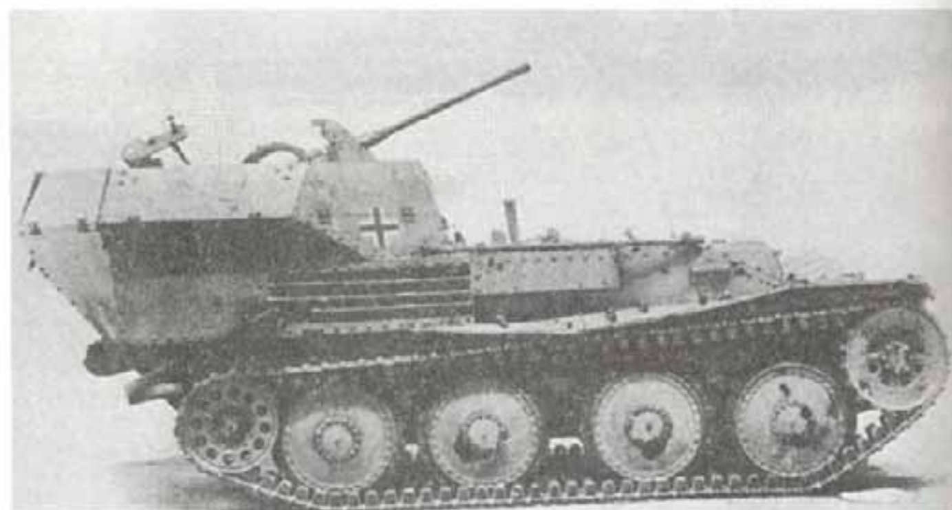
20-мм зенитное орудие на шасси Gw. 38 (t). Первая ЗСУ вермахта, применялась с 1943 года.
