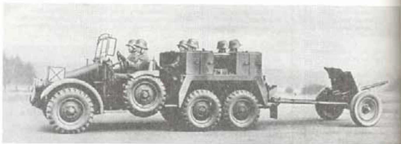
Эта важнейшая конструкция дала свое название «передку Крупп»: «Крупп» L2 H 43 и L2 H 143 как моторизованный передок артиллерийского орудия категории машин 69, предназначенный в качестве тягача для перевозки легких противотанковых или зенитных орудий.
