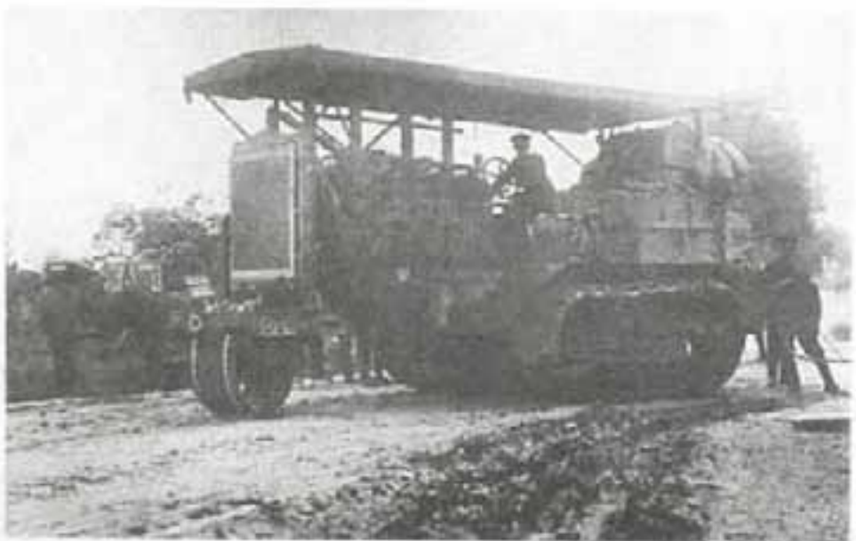
Гусеничный трактор модели 1901–1902 гг. американской фирмы «Холт-Катерпиллер» (Holt Caterpillar) использовался австрийцами для перевозки по пересеченной местности 305-, 380- и 420-мм орудий. Его четырехцилиндровый двигатель имел мощность 70 л. с. при 450 (1) об/мин и работал на бензине или керосине. Рычажное управление гусеницами, червячное – ведущим колесом. В распоряжении англичан находились 1500 единиц таких гусеничных тракторов.
