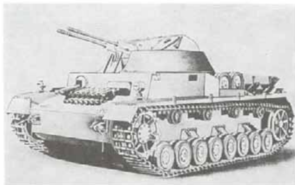
ЗСУ «Кугельблиц» на шасси танка Pz IV (с 30-мм двухствольной установкой), прототип 1944/45 гг.)
