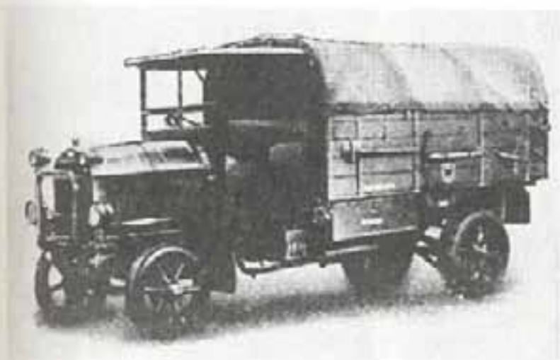
Войсковой грузовой автомобиль «Штйвер» LGS, 42 л. с., полезная нагрузка 5 т.
