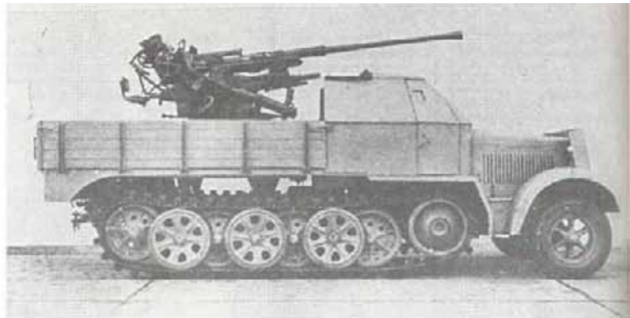
Самоходный лафет для 37-мм ЗП на тягаче 8 т (Sd Kfz 7/2). Окончательная конструкция с бронированной кабиной водителя, защитой радиатора и деревянной бортовой платформой.
