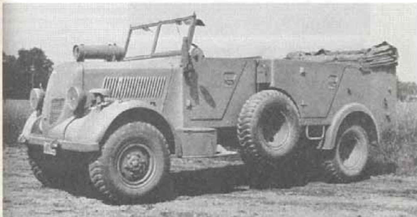
Модель «Феномен Гранит» 1500 А, командный автомобиль с «тропическими» шинами (внедорожный протектор), 1942–1943 гг.
