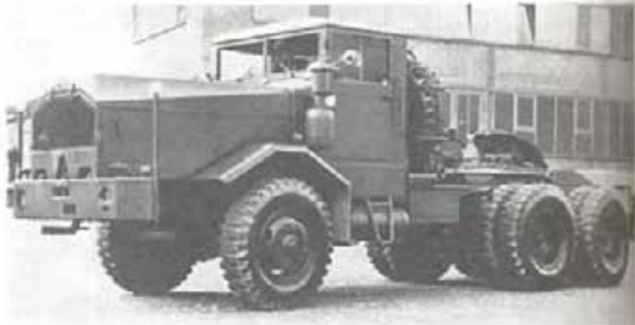
«Фаун» L 912/45 A был тяжелым грузовым автомобилем на 15 т груза, оснащенным дизелем V 12 системы «Дойц».
