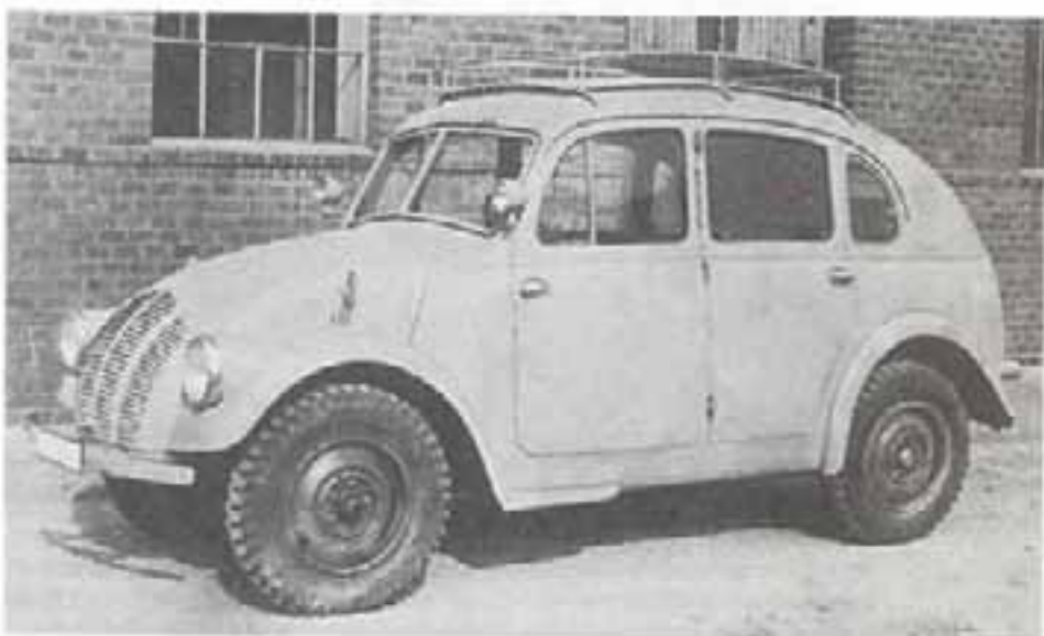
Фирма «Татра» производила в 1940 г. автомобиль повышенной проходимости V809, несколько экземпляров которого поставлялось в Африканский корпус. Характеристики этой машины: 4 цилиндра, рабочий объем 2,5 л, 50 л. с., воздушное охлаждение, четырехступенчатая коробка передач и промежуточная передача, привод на все колеса, база 2600 мм, габаритные размеры: 3720 x 1600 x 2000 мм. На базе этой модели по заказу генерала Роммеля в 1942 г. был изготовлен лимузин для эксплуатации в условиях тропиков (фото внизу). Однако кроме этой фотографии других материалов или характеристик машины не сохранилось.
