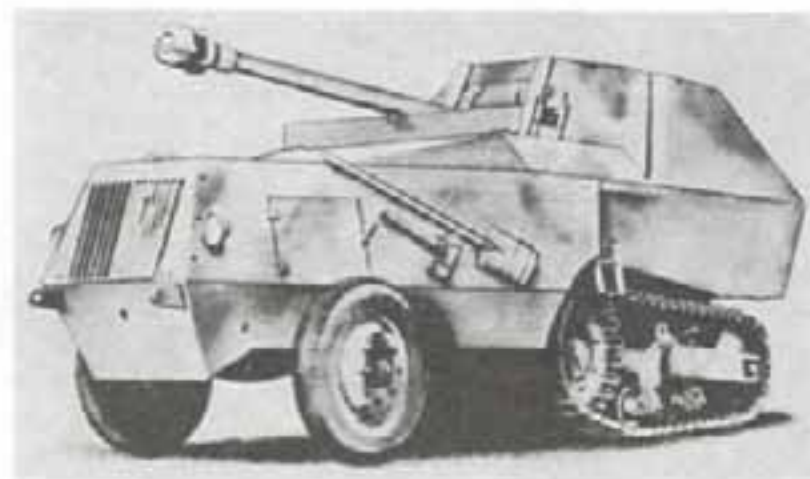
Французский полугусеничный тягач «SOMUA-Кегресс» с 75-мм ПТП Rak 40 L/46 был сильно перегружен.
