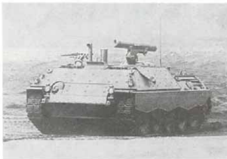
Ракетный истребитель танков 3 «Ягуар 1» с противотанковой управляемой ракетой HOT. Переоснащение 1978–1981 гг.
