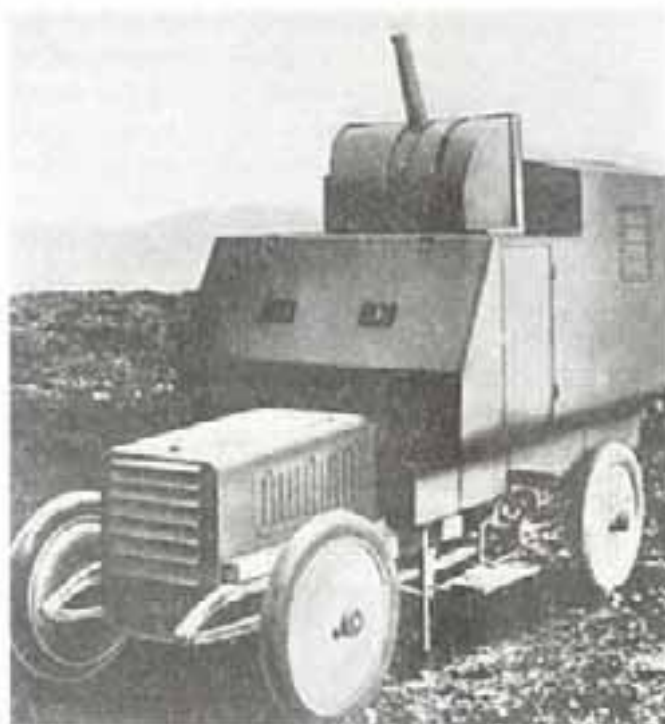
Генрих Эрхардт предпринял следующую попытку создать бронированный хорошо вооруженный военный автомобиль. Это оказалась полубронированная машина с 50-мм зенитной пушкой обр. С/1908.
