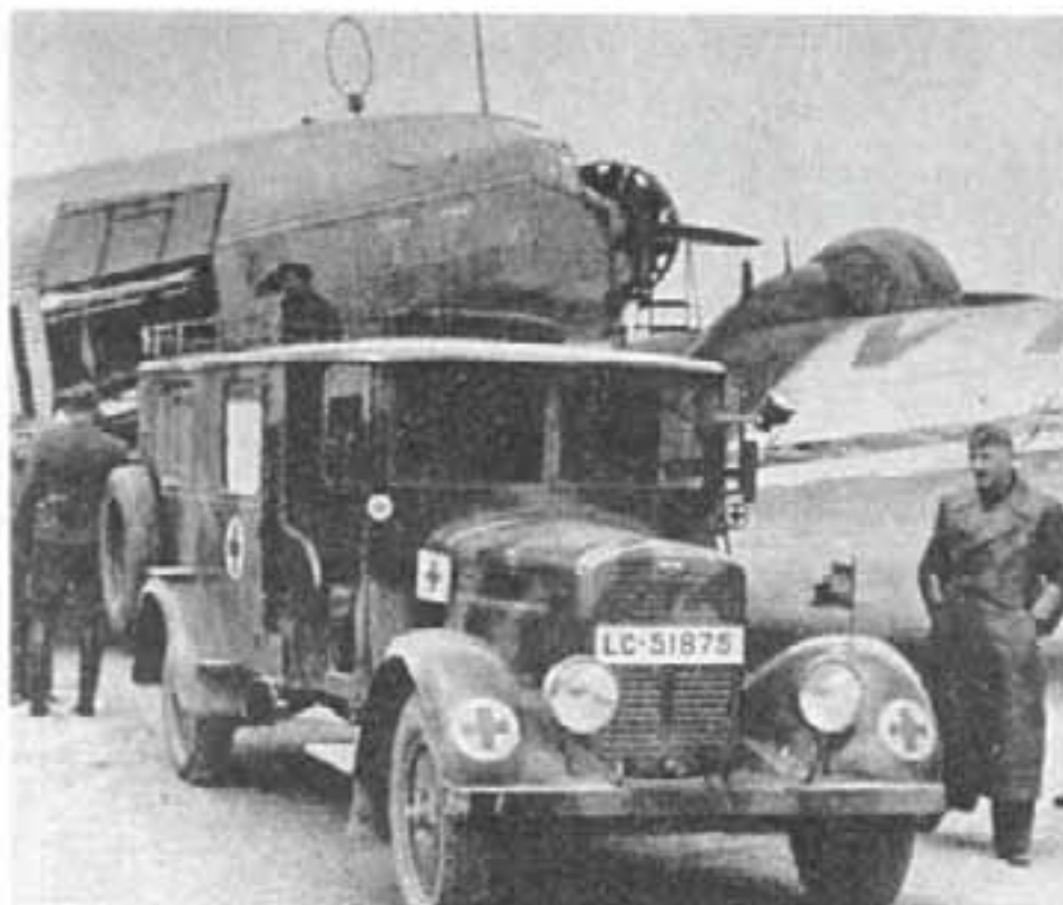
Первые санитарные машины, которые поставляла в вермахт фирма «Феномен», имели закрытое сверху, но полностью открытое с обеих сторон сиденье водителя, как у юбелямагена. На фотографии показан автомобиль, который использовался в легионе «Кондор» во время гражданской войны в Испании.
