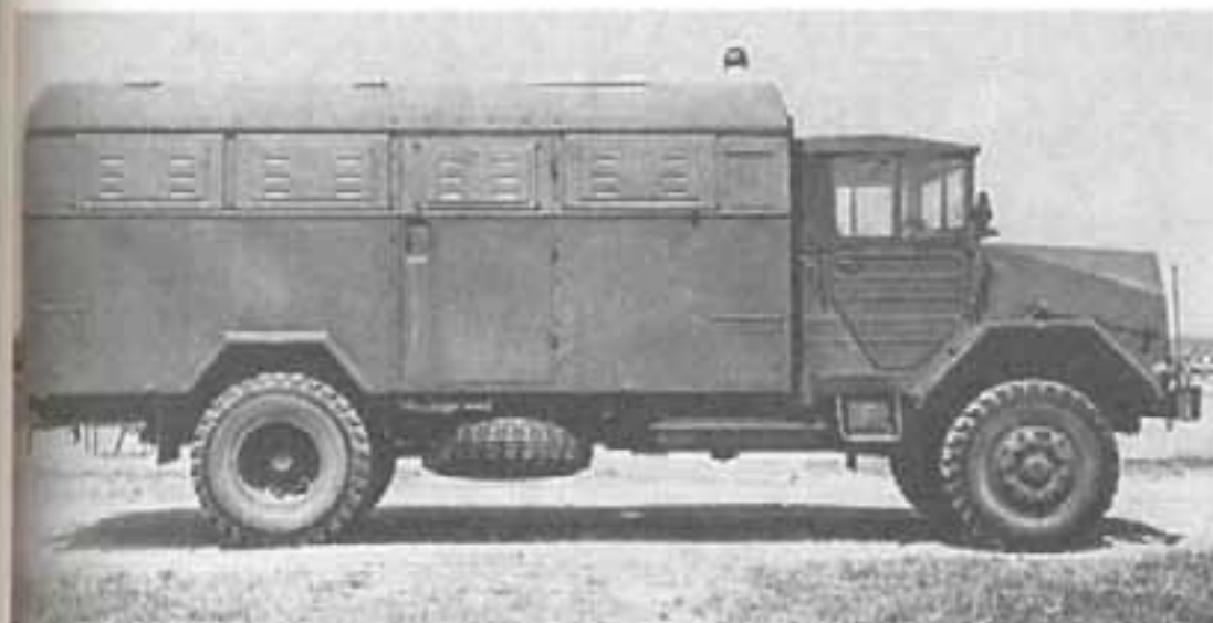
Грузовой автомобиль повышенной проходимости 5 т MAN 630 L 2 A с кузовом-фургоном. Задние колеса со двойными шинами
