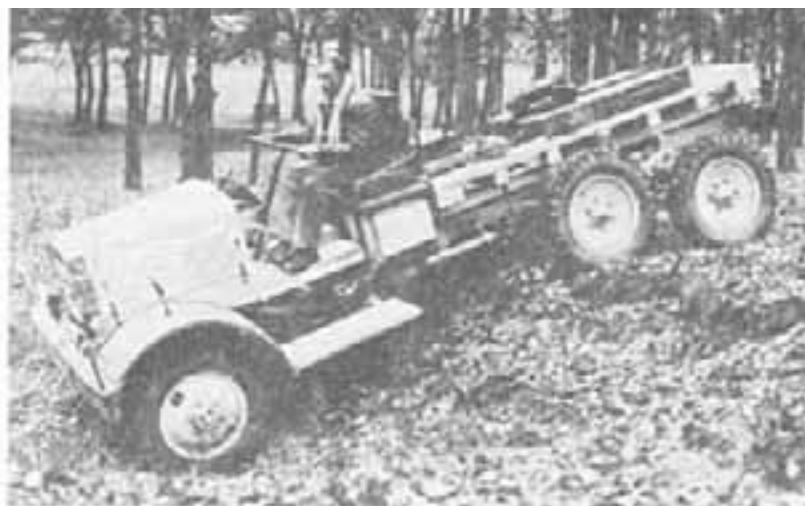
Опытное шасси для будущего «типового дизеля» при ходовых испытаниях в условиях пересеченной местности вблизи города Нюрнберга. Здесь использован пока еще хромированный радиатор обычного грузового автомобиля фирмы MAN.
