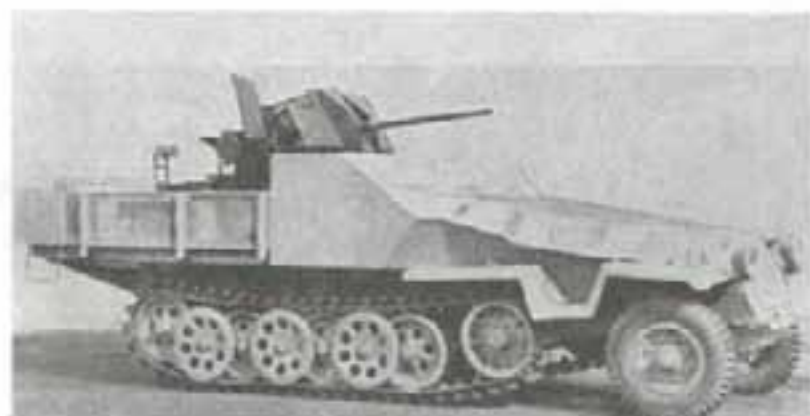
БТР Sd Kfz 25 1/17 с 20-мм зенитным орудием. Кузов без брони, чтобы не ограничивать углы стрельбы пушки.
