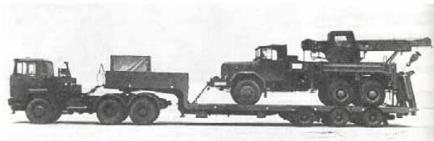
С помощью буровой установки В 3 А, установленной на автомобиле «Магирус-Дойц» (6 х 6), саперы могут во всех горных породах бурить скважины глубиной до 25 м.
