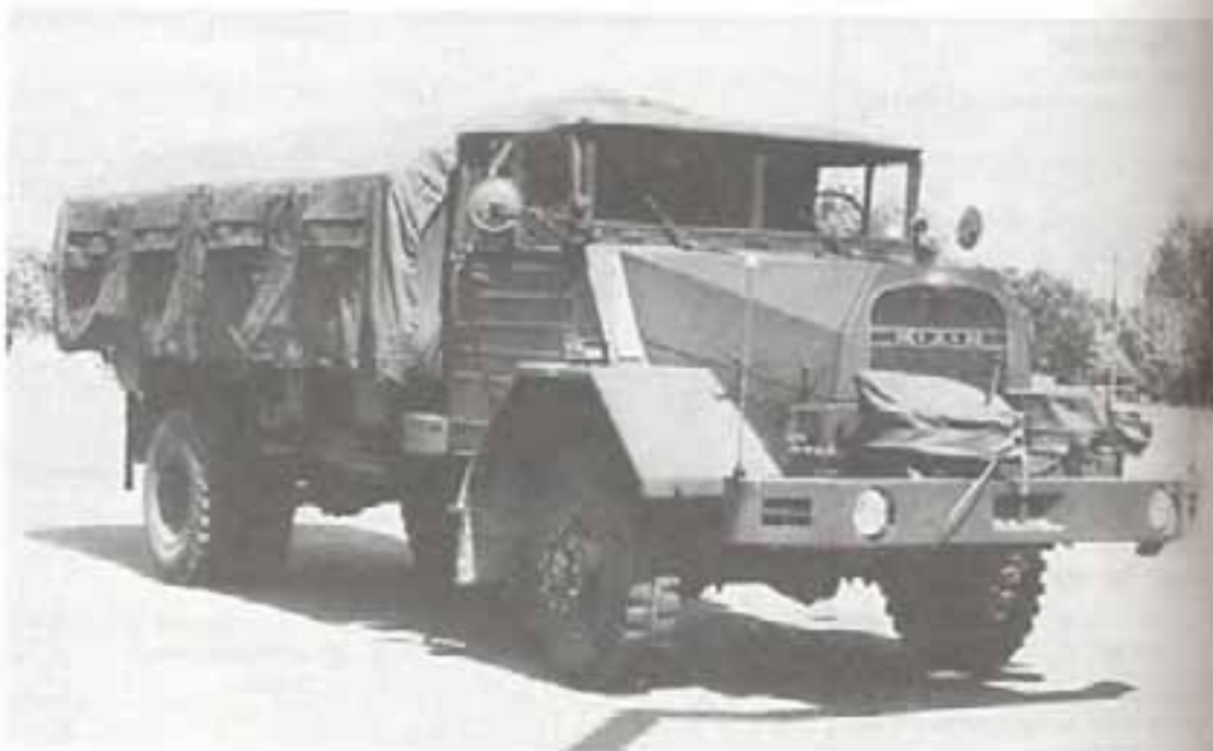
Грузовой автомобиль повышенной проходимости 5 т MAN 630 L 2 A с лебедкой. Сдвоенные шины на задних колесах
