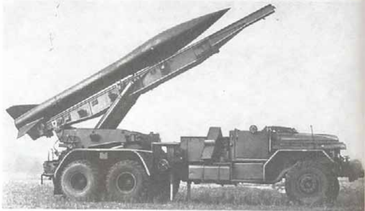
Ракетная пусковая установка «Онест Джон» (М-386) на американском грузовом автомобиле М-139 F. Габаритные размеры 9890 x 2900 x 2670 мм, вес 16,4 т, калибр ракеты 761 мм, дальность поражения цели до 38 км. Кроме этого автомобиля для ракетной пусковой установки, ракетные подразделения «Онест Джон» использовали американский грузовой автомобиль для перевозки ракет. Ракеты класса «земля – земля» «Онест Джон» в середине семидесятых годов были заменены ракетной системой «Ланс».
