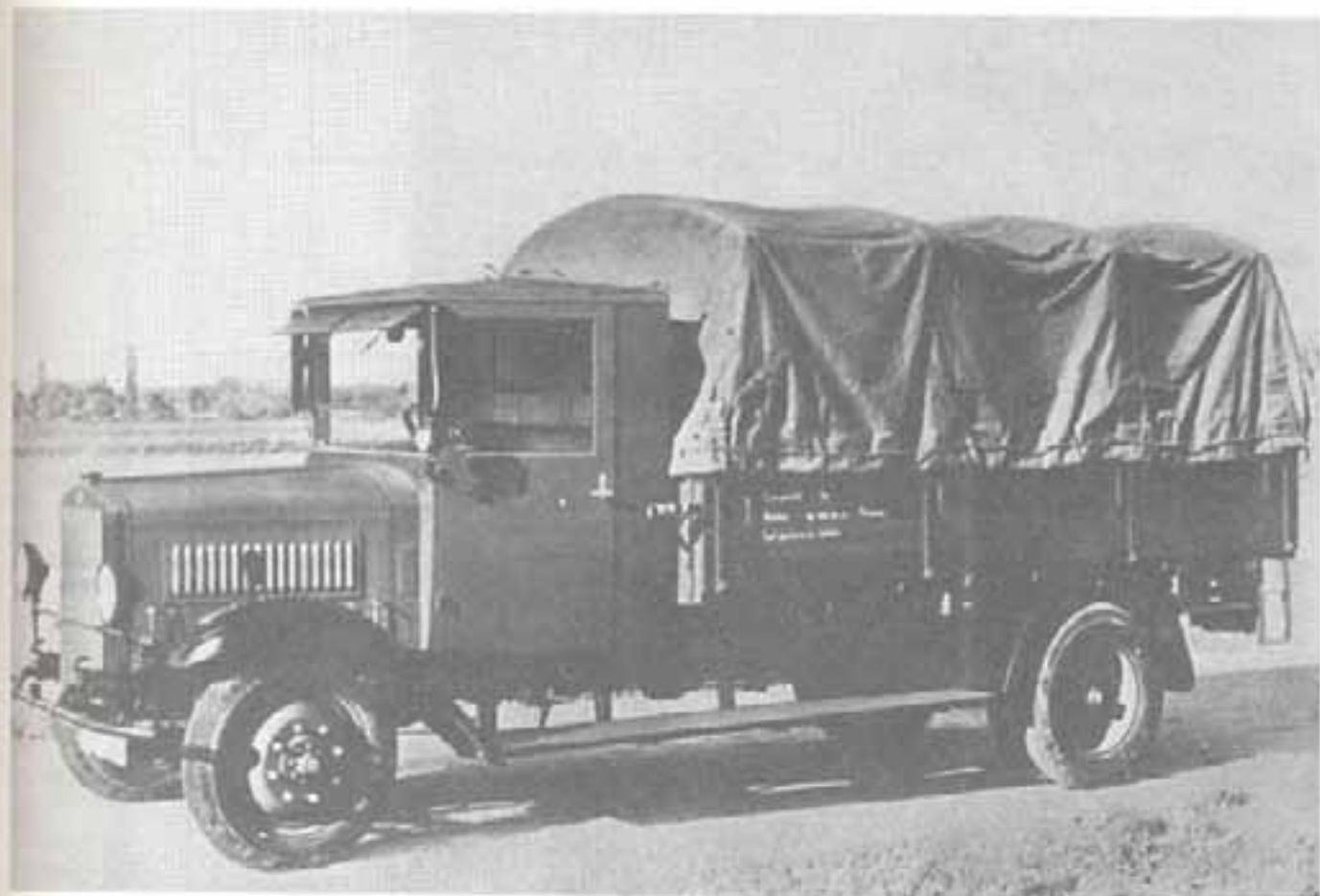
Грузовой автомобиль райхсвера «Мерседес-Бенц» тип L 45, грузоподъемность 2,5 т, 1929–1930 гг.
