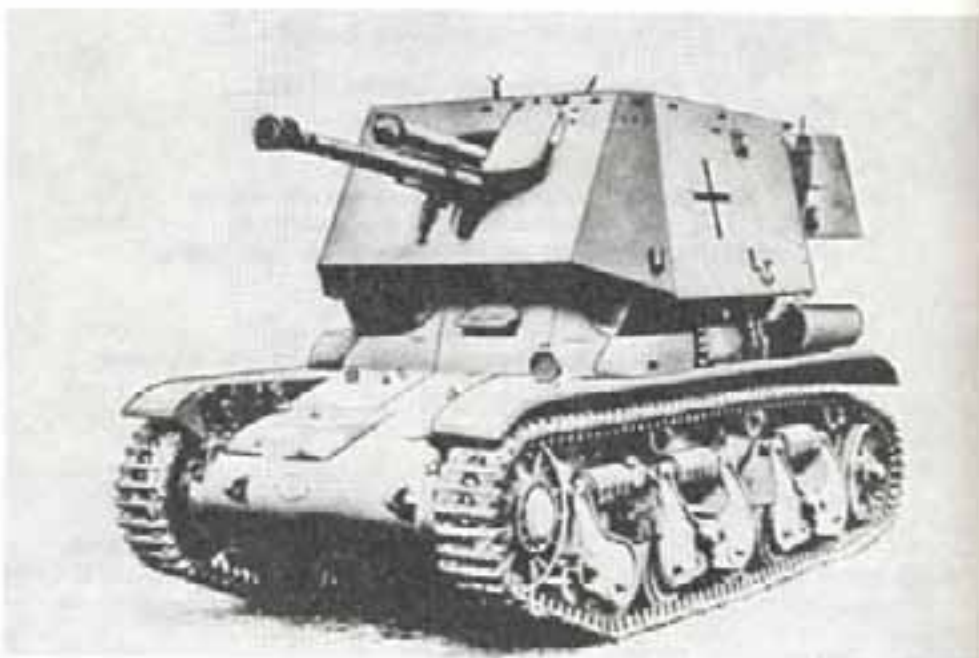
47-мм пушка 4,7 cm Pak (f) на шасси танка «Рено» R 35 (Франция)
