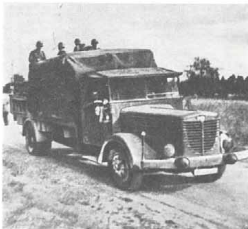
«Буик-НАГ» из далеких предвоенных времен, переоборудованный как грузовой автомобиль с бортовой платформой с типовой кабиной водителя. На двух нижних снимках изображен «Буик-НАГ» тип 4500 А-1 (Модель 1942/43 гг.).
