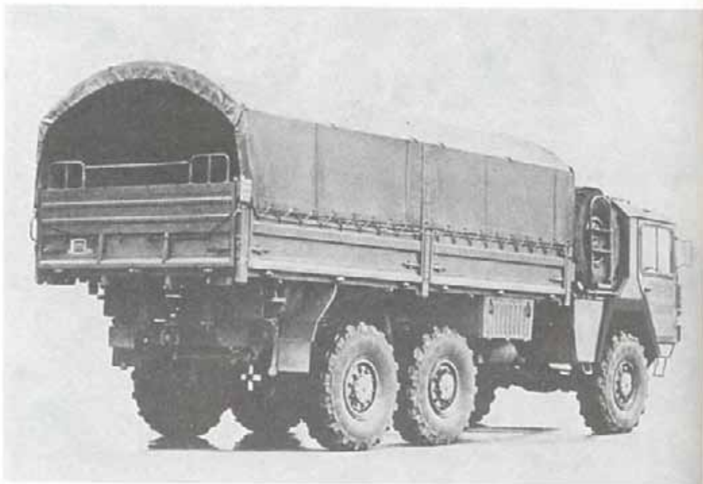
Грузовой автомобиль повышенной проходимости 7 т (6 х 6) MAN N 4520 с бортовой платформой с 1977 г.
