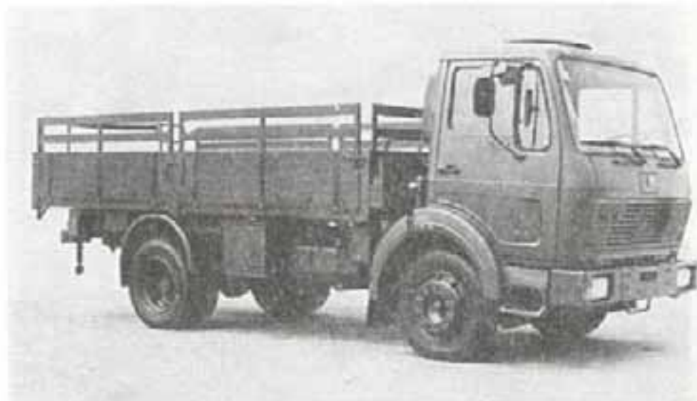
Грузовой автомобиль 5 т (4 x 2) «Мерседес-Бенц» L 1017 A Автомобиль с бортовой платформой
