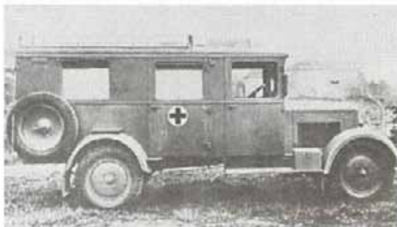
«Феномен Гранит» 2500 Н – старейшая конструкция санитарного автомобиля в составе вермахта категории Kfz. 31, выпускавшаяся с 1936 по 1939 г.
