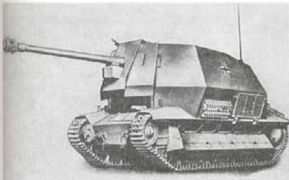
75-мм ПТП L/46 на шасси танка F.C.M. (Франция)
