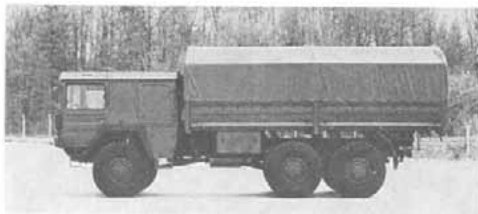
Грузовой автомобиль повышенной проходимости 7 т (6 х 6) MAN N 4520 с бортовой платформой с 1977 г.
