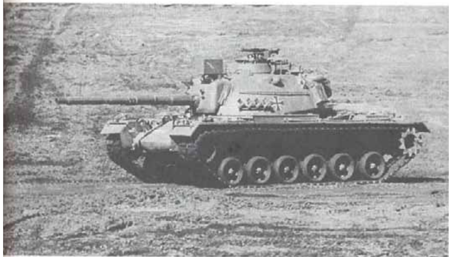
Средний боевой танк М-48 А 2 со 105-мм пушкой (Модернизация в 1978–1980 гг.)
