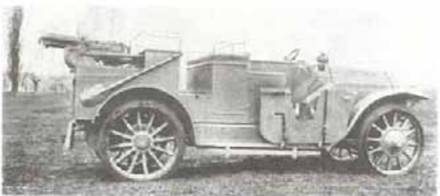
Автомобиль конструкции Даймлера с установленными на нем пулеметами (облегченный привод на четыре колеса), мощность авиационного двигателя системы Даймлера — 70 л. с. Опытный образец 1914 г.
