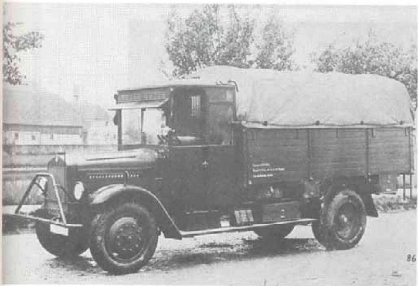
Командный автомобиль райхсвера «Мерседес-Бенц» тип L 3000, грузоподъемность 3 т.
