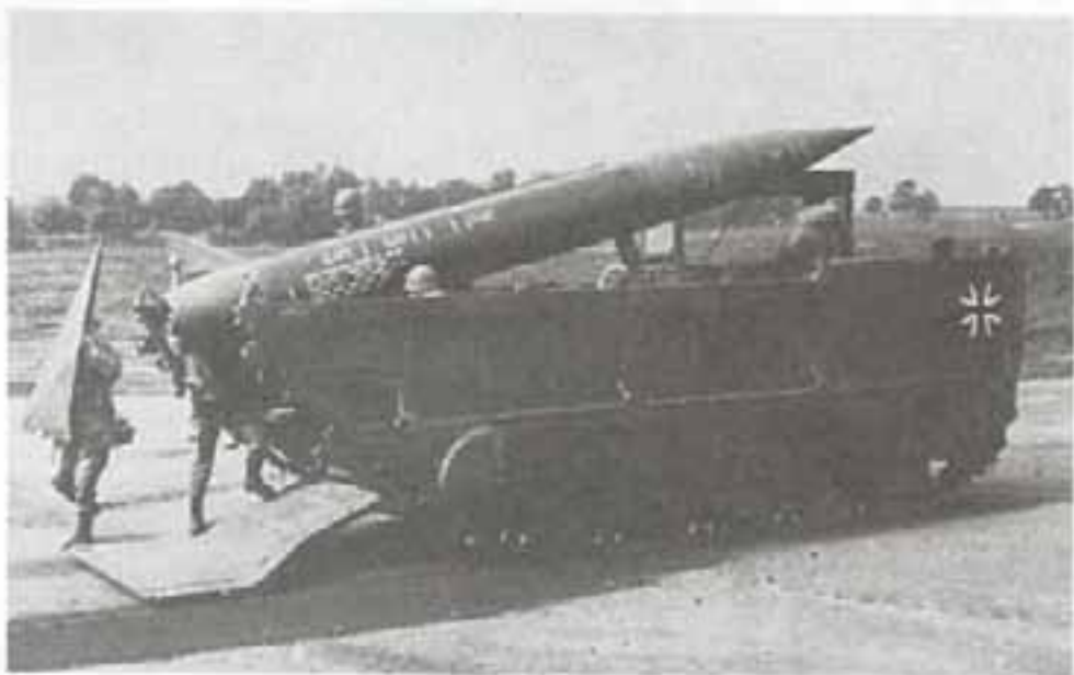
Тактический ракетный комплекс «Лано» класса «земля — земля» (дальность полета 120 км)
