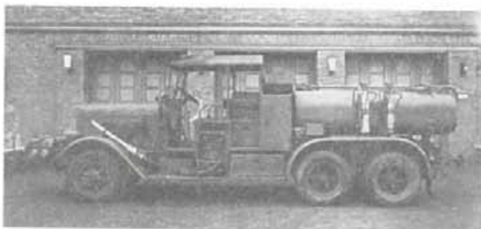
«Хеншель» тип 33 D1 в качестве аэродромного топливозаправщика TS 2,5 с установленным спереди насосом, с 1937 г. поставлялся фирмой «Мец» (Карлсруэ) в военно-воздушные силы.
