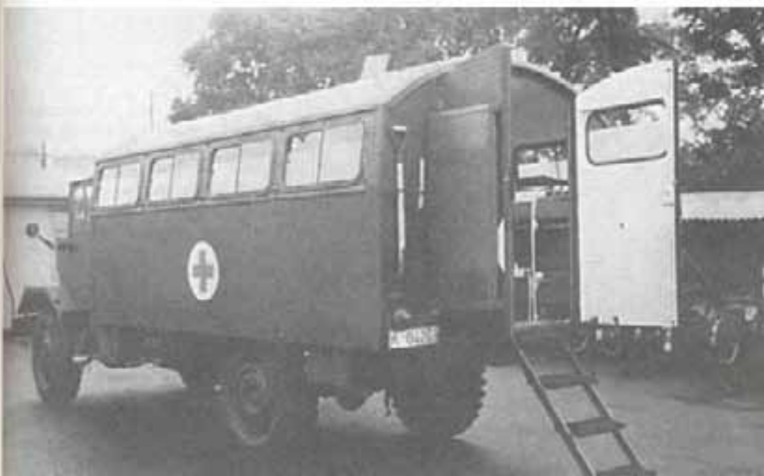
Грузовой автомобиль повышенной проходимости 5 т MAN 630 L 2 A с кузовом-фургоном в качестве санитарного автомобиля большой вместимости, кузов производства «Миезен»
