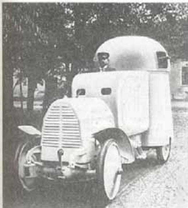
Первый в мире бронированный автомобиль построил Пауль Даймлер на своих австрийских заводах в 1903-1905 гг. Характеристики: 4 цилиндра, рабочий объем 4400 см 3 , 30 л. с. при 1050 об/мин, привод на все колеса, вес 2 т, экипаж 4 человека, вооружение — 37-мм пушка и 2 пулемета, скорость до 45 км/ч.
