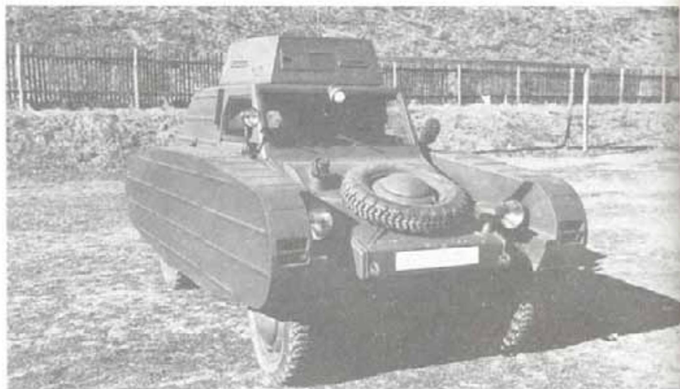
Даже юбелягены «Фольксвагена» использовались во время войны в целях обучения и совершенствования навыков вождения боевых машин как макеты бронированных боевых машин. Машина имела кузов-башню для установки в ней пулемета. Посадка в машину производилась с кормы. Все снимки сделаны в мае 1941 г.
