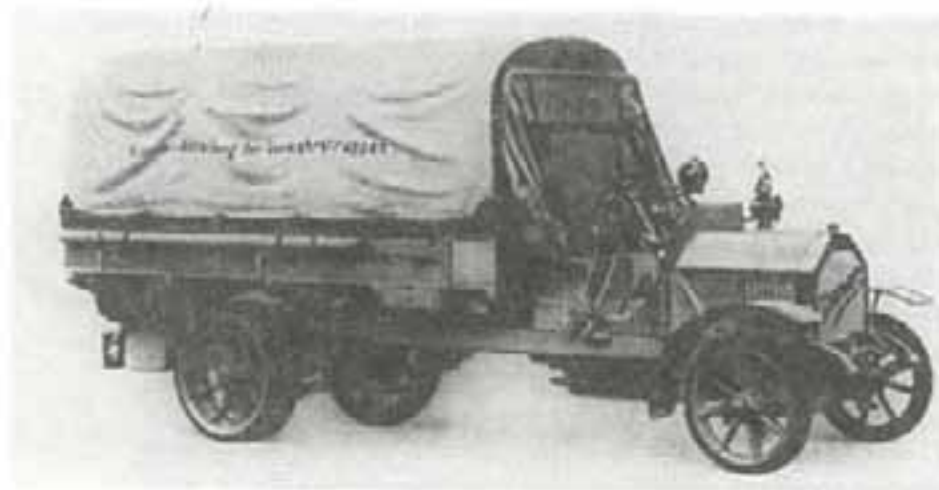
Грузовой автомобиль «Штейер» 1907 г. Четырехцилиндровый двигатель мощностью 32 л. с., цепная передача, собственный вес 4 т, полезная нагрузка 4 т.
