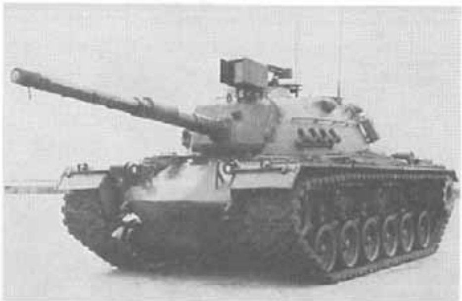
Средний боевой танк М-48 А 2 со 105-мм пушкой (Модернизация в 1978–1980 гг.)
