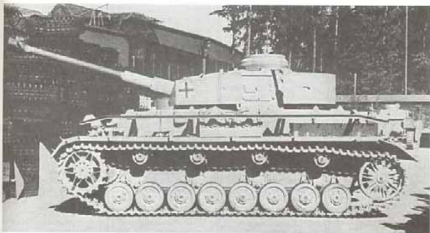
Танк Pz IVJ с боковой шиной для подвешивания фартуков
