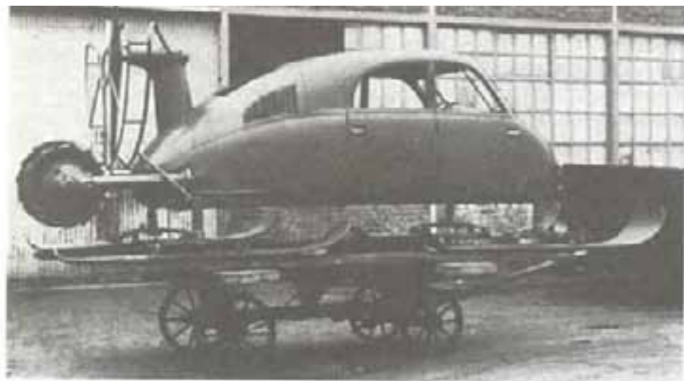
«Татра» V 855 — это аэросани, которые в 1942 г. выпускал завод «Татра» с использованием двигателя T 87. Насколько известно, сохранился лишь единственный прототип их, который и до сегодняшнего дня стоит в тамошнем заводском музее.
