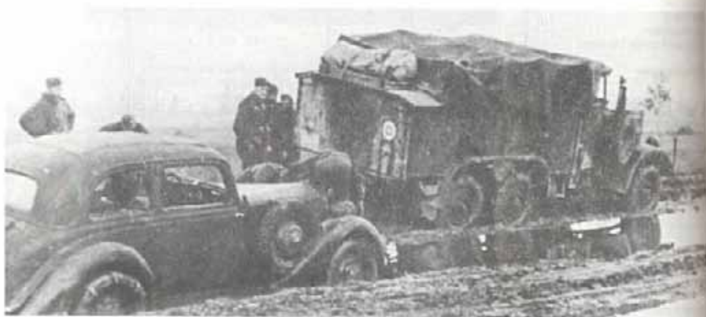
«Типовой дизель» в качестве грузового автомобиля-лаборатории категории машин Kfz. 63. Осенняя распутица южнее Ржева поздней осенью 1941 г.
