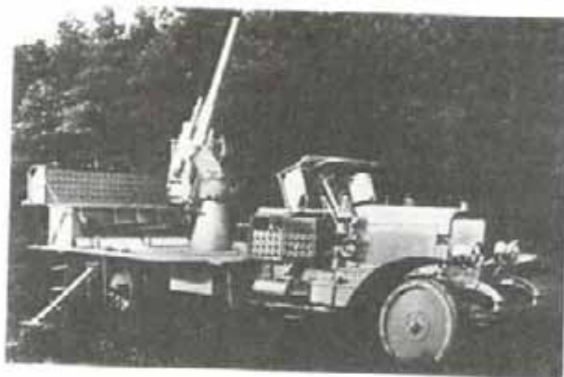
65-мм пушка L-35 для стрельбы по аэростатам («Райнметалл»), установленная на грузовом автомобиле «Эрхардт», в походном положении (верхнее фото) и на огневой позиции (нижнее фото). В производстве с 1910 г.
