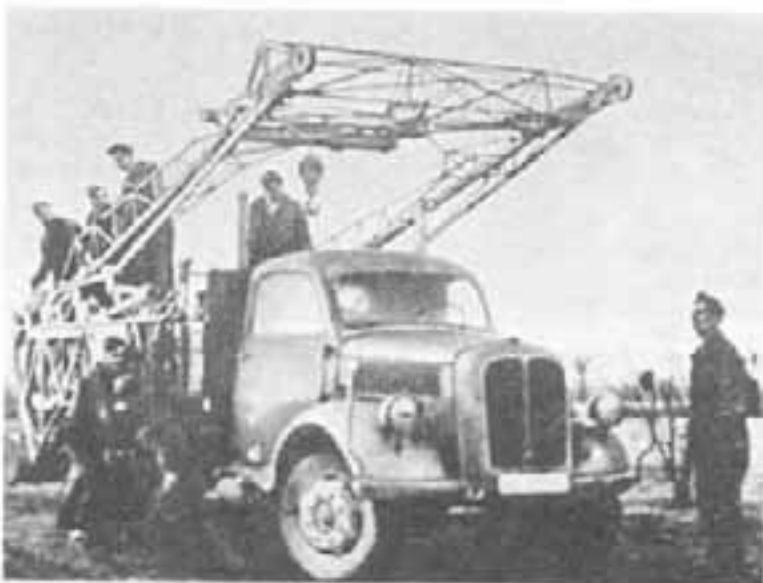
«Боргвард» В 3000 в качестве автомобильного крана, предназначенного для смены авиационных двигателей.
