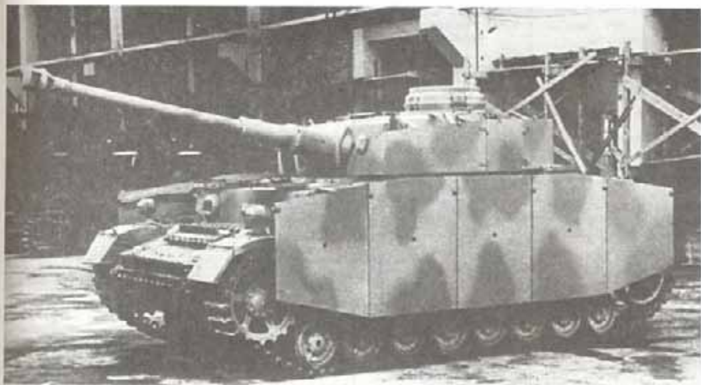
Танк Pz IVH с длиной 75-мм пушкой и с экранами
