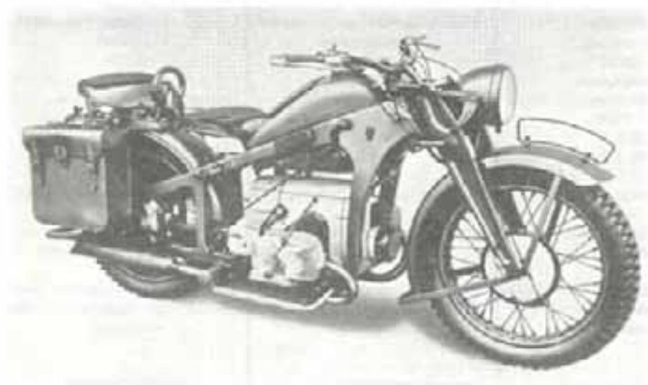
Тяжелый мотоцикл 600 см 3 «Цюндапп» K600W
