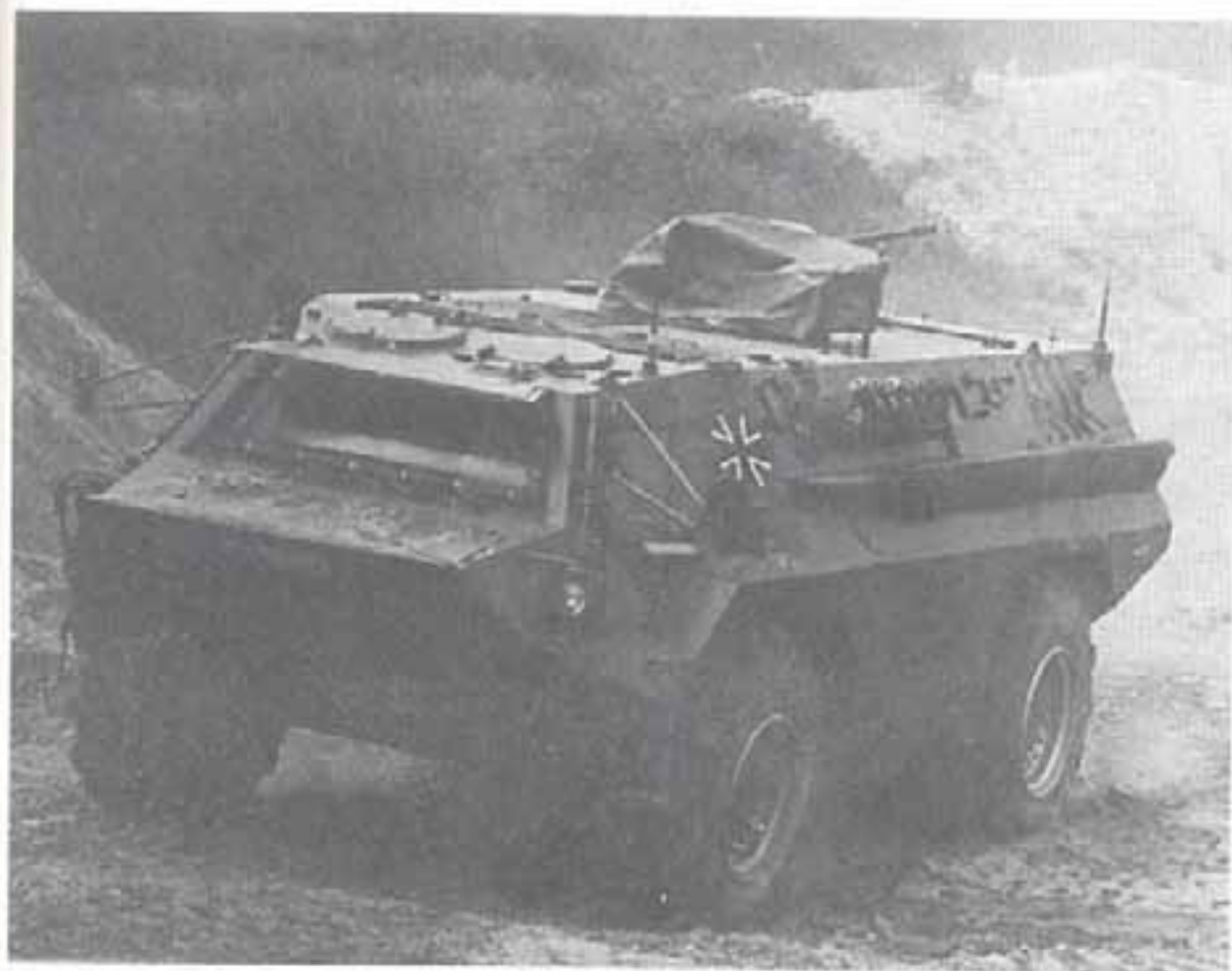
Саперно-разведывательный автомобиль-амфибия. Прототип 1977 г., дальнейшая разработка прекращена
