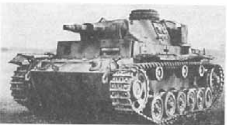
Танк Pz IIIH «штурмовой танк» с 75-мм орудием L/24
