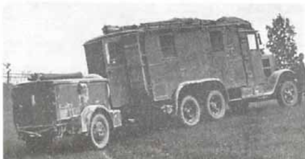
«Крупп» L 3 H 163 в качестве большого грузового автомобиля связи категории машин Kfz. 62 или 63.
