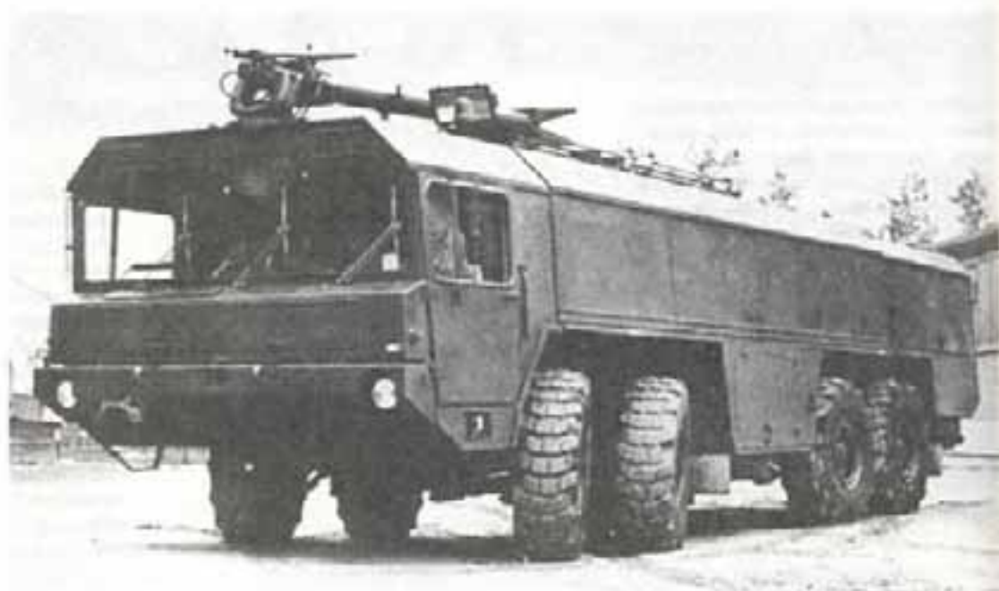
Пожарный автомобиль 8000 «Фаун» 6 х 6, с двумя ВО дизелями «Дойц», 320 л. с., 8000 л воды, 900 л пенообразующего средства. Кузов и оборудование: «Кроненбург» (Голландия).
