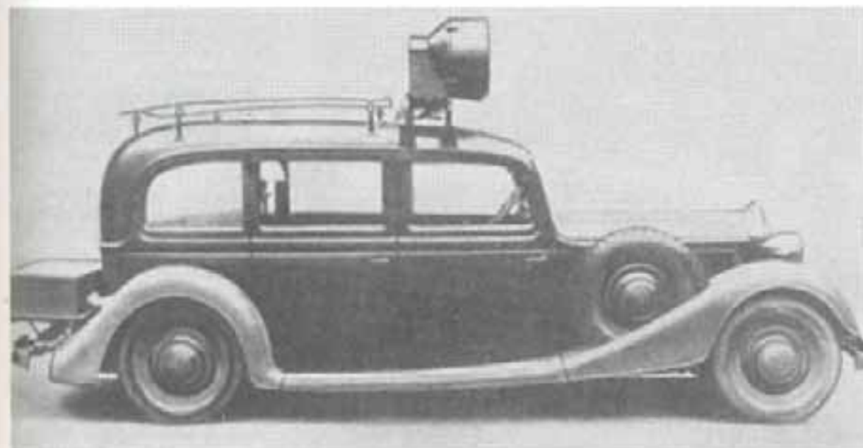
Тяжелый легковой автомобиль «Хорх» 830 BL (пульман-лимузин) для небольшого моторизованного подразделения с громкоговорителем предназначен для ведения пропаганды «среди населения».
