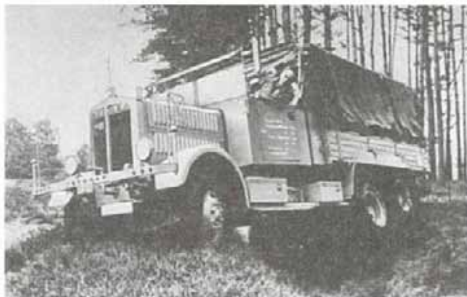
«Бюссинг-NAG» тип GL6 – средний грузовой автомобиль повышенной проходимости грузоподъемностью 3 т
