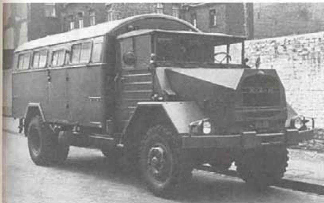
Грузовой автомобиль повышенной проходимости 5 т MAN 630 L 2 A с кузовом-фургоном. Задние колеса со двойными шинами
