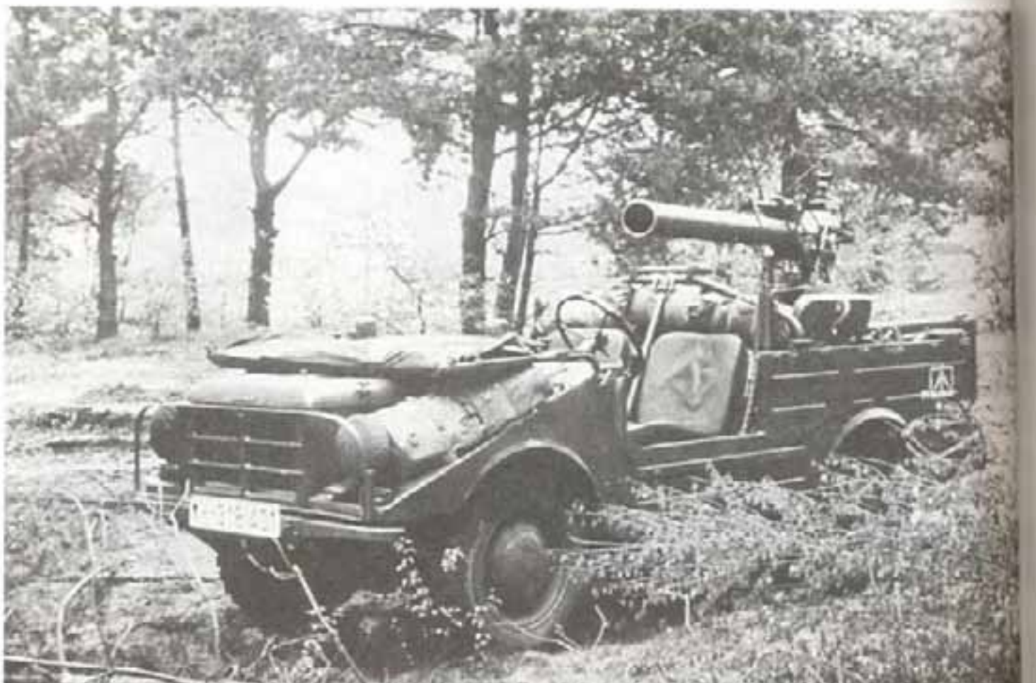
Противотанковая ракетная система «Кобра», здесь — установленная на автомобиль повышенной проходимости фирмы «Ауто Унион» и DKW, — была разработана в свое время фирмой «Вильков» (Оттобрунн), в настоящее время — фирма MBV. Дальность действия управляемой ракеты составляла до 2 000 м. — Машина DKW 0,25 т использовалась также в качестве носителя безоткатных орудий калибра 75, а также 1106 мм, использовавшихся в десантных войсках и в истребительных батальонах территориальных войск.
