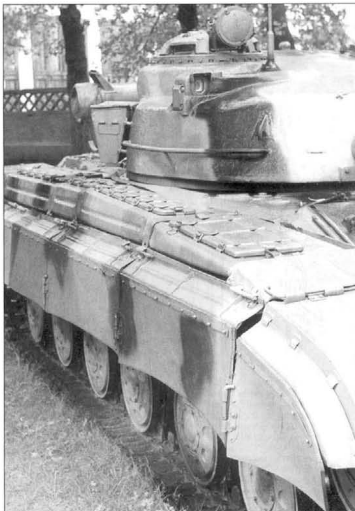
Т-64А выпуска до 1972 г. после капитального ремонта. Отличительная особенность ранних Т-64А – ящики ЗИП на правой надгусеничной полке. Model 1972 T-64A after major overhaul. Distinctive feature of the early T-64A is spare devices boxes on the right over caterpillar shelf.
