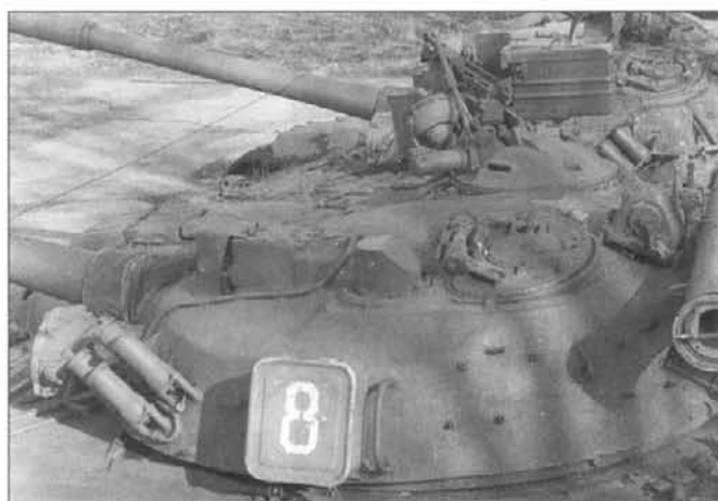
Танк Т-64Б-1. На башне танка отсутствует надбой. Фото В.Петрусенко. T-64B-1 tank. There is no auxiliary armor on the tank turret.
