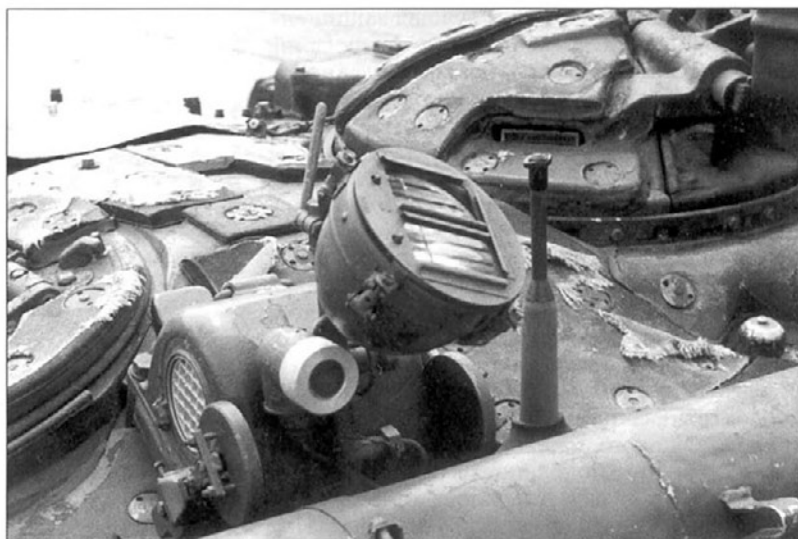
Размещение датчика бокового ветра на корме башни. Вверху датчик открыт. Cross-wind sensor mounting on the turret rear. The sensor is open above.
