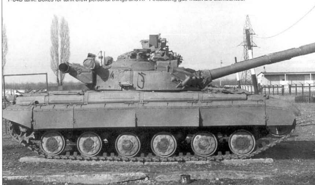
Танк Т-64Б. Ящики для личных вещей экипажа и изолирующего противогаса АТ-1 сняты. Все фото В.Петрусенко. T-64B tank. Boxes for tank crew personal things and AT-1 insulating gas-mask are dismounted.
