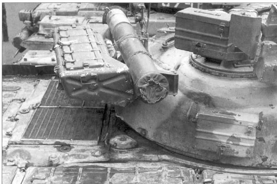
Танк "гибрид". Т-64А выпуска до 1974 года. После капитального ремонта смешанная укладка ЗИП – ящик ЗИП ОПВТ как у машин после 1974 г. Обратите внимание на нестандартное крепление ящика с помощью тросиков. "Десна", июль 2000 г. Фото В. Чобитка. Model 1974 T-64A tank "hybrid". After major overhaul there is spare devices mixed packing as Model 1974 cars had. Notice the substandard box tier with a small cable. "Desna", July 2000.
