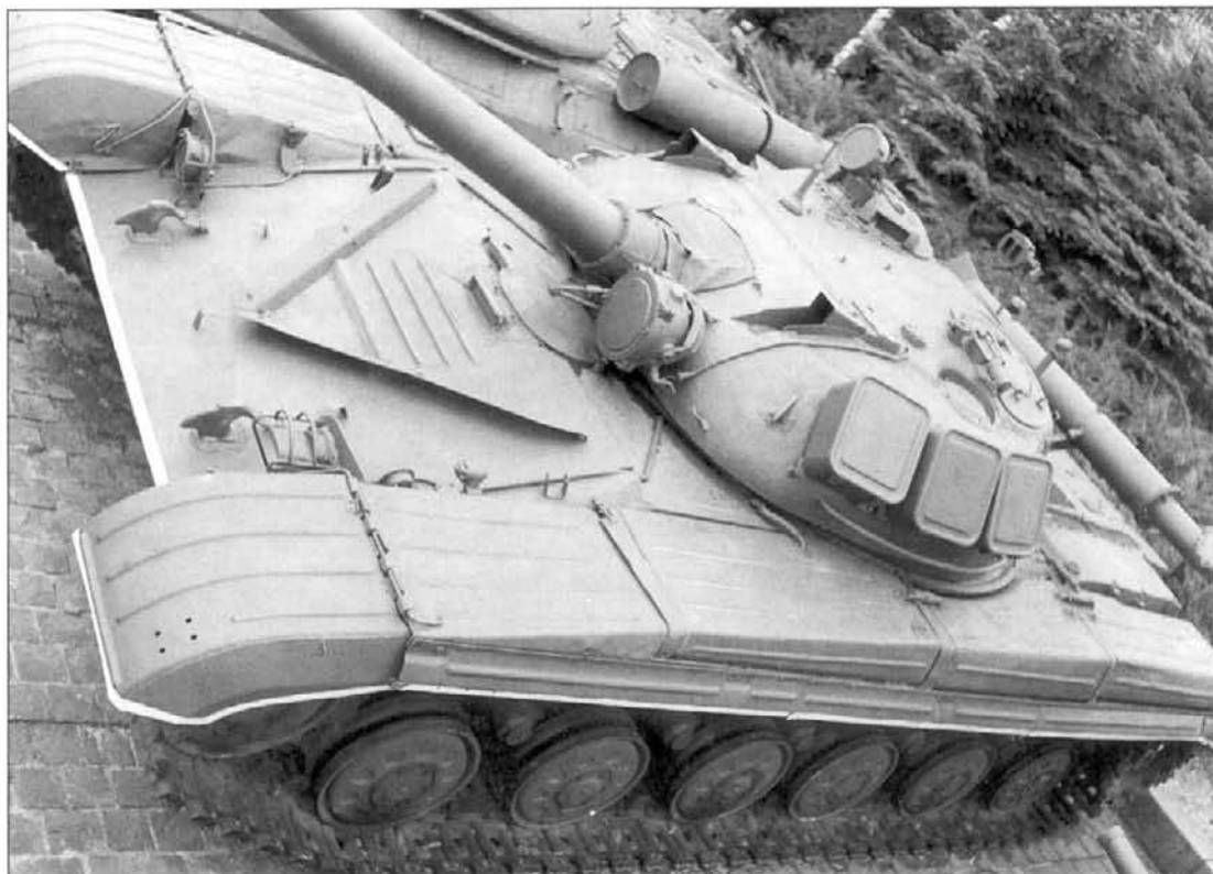
Т-64Р. Музей ВОВ в г. Киев. В отличие от танка Т-64 (об. 432) на лобовом листе установлен грязевой щиток и доварены пулеотбойные прутки для защиты смотрового прибора механика-водителя.
