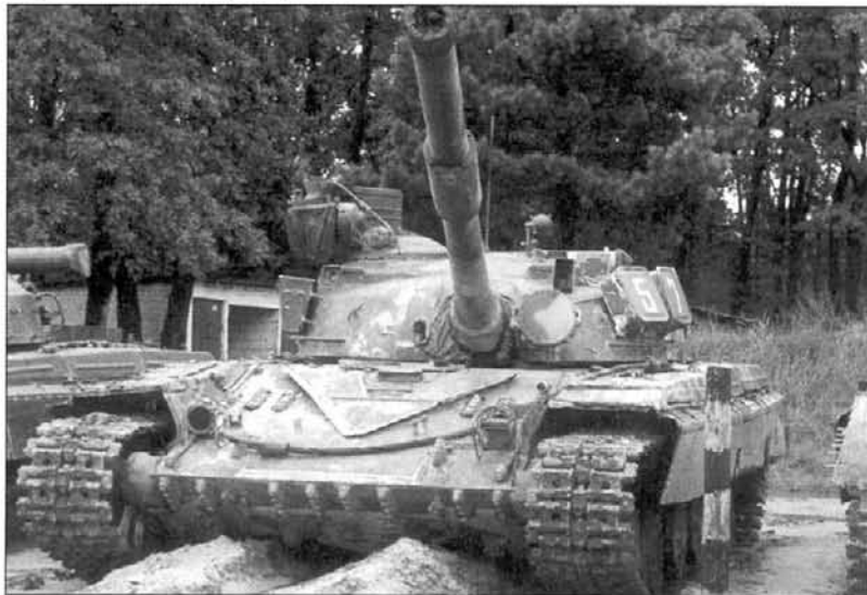
Танк Т-64А выпуска 1976 г. после капремонта на танкодроме. Подкрылки "снесены" в результате неудачного вождения. 5 тп, уч. центр "Десна", июль 2000 г.
