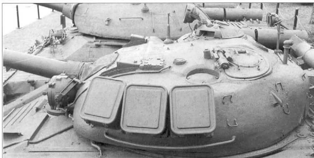
Вид на башню со стороны левого борта. Размещение ящиков АТ-1 как у танка Т-64А.
