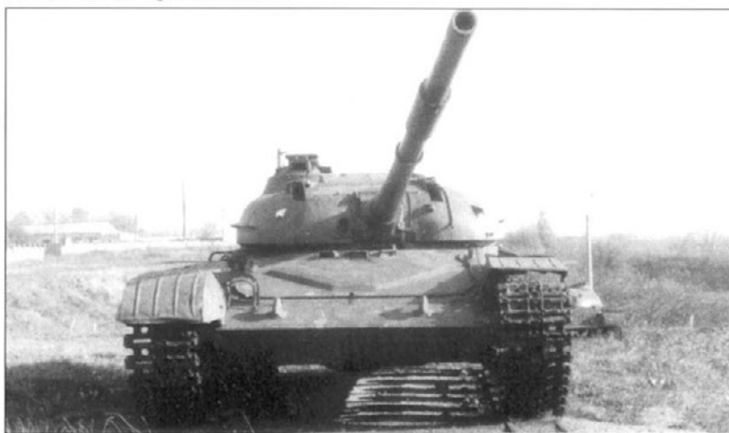
Танк Т-64 (объект 432) со 115 мм пушкой. Обратите внимание на бронирование верхней лобовой части корпуса, г. Бердичев. Фото из коллекции М. Саенко. Т-64 tank "object 432" with 115-mm gun. Notice the top front hull armor, Berdichev.
