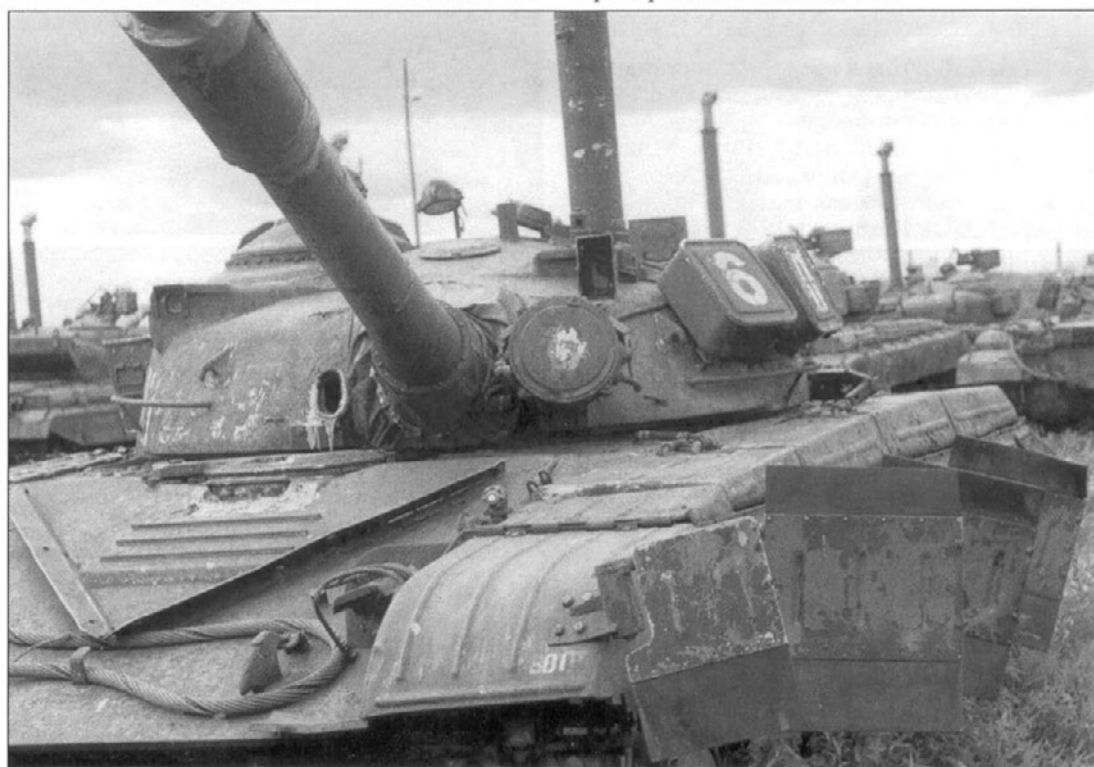
Установка комбинированного антенного устройства на танках Т-64АК. A combined antenna device mounting on T-64AK tanks.
