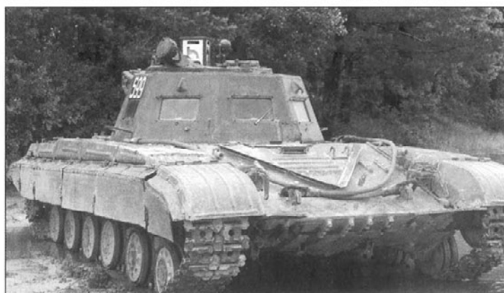
ХТВ (ходовой тренажер вождения) разработан в КТЦ (конструкторско-технологический центр) г. Киева, выпускался 115-м БТРЗ на базе танка Т-64А. Вместо башни установлена кабина механика-инструктора. Driving simulator (HTV) developed in design-technological center in Kiev. 115th tank repair plant produced on the basis of T-64A tank. It has mechanic-instructor's cabin instead of the turret.
