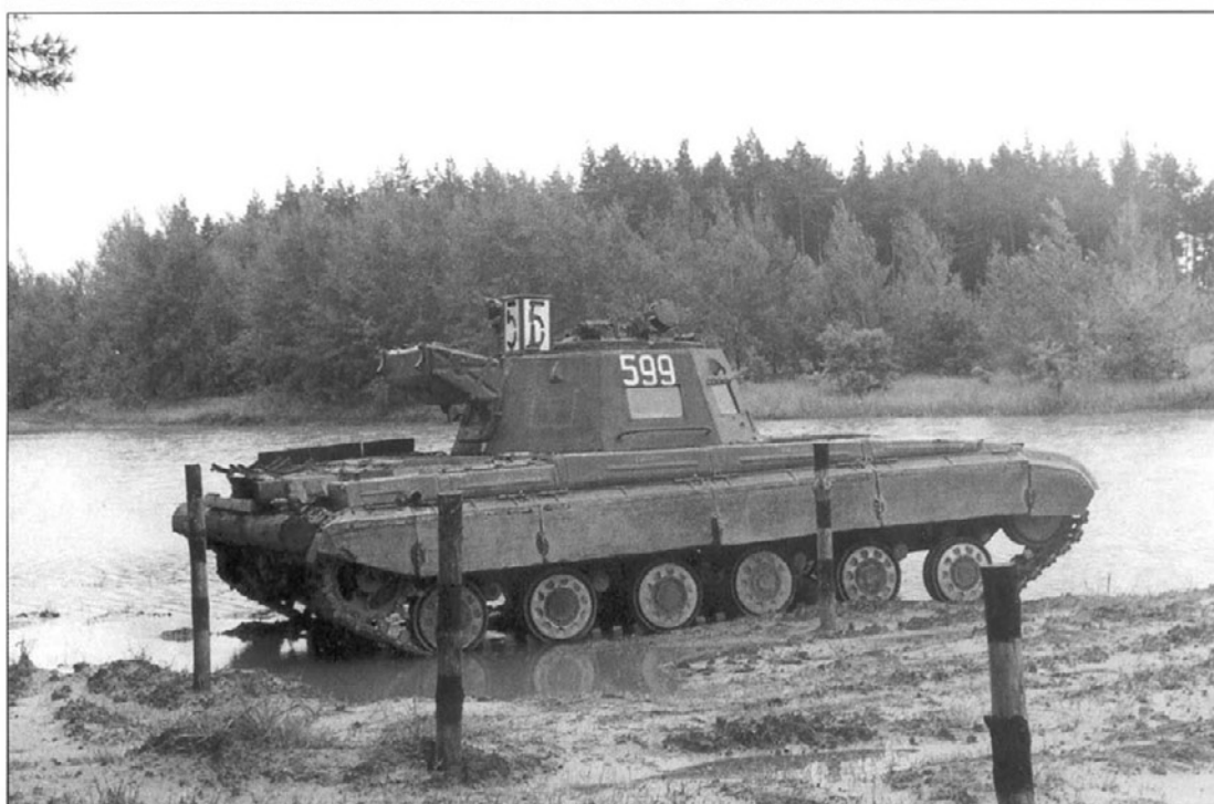
ХТВ (ходовой тренажер вождения) разработан в КТЦ (конструкторско-технологический центр) г. Киева, выпускался 115-м БТРЗ на базе танка Т-64А. Вместо башни установлена кабина механика-инструктора. Driving simulator (HTV) developed in design-technological center in Kiev. 115th tank repair plant produced on the basis of T-64A tank. It has mechanic-instructor's cabin instead of the turret.
