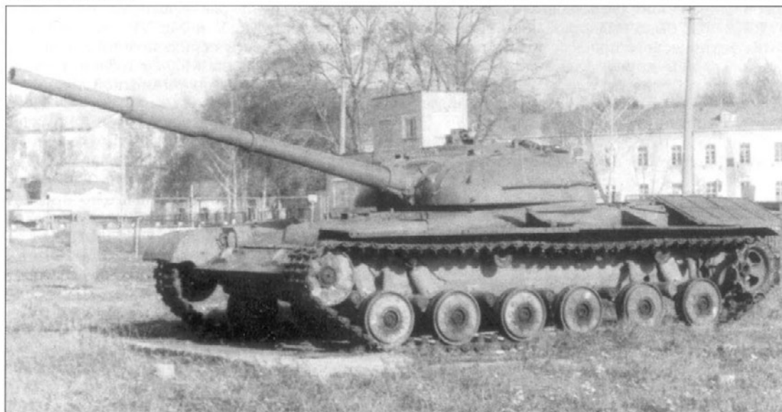
Танк Т-64 (объект 432) со 115 мм пушкой. Обратите внимание на бронирование верхней лобовой части корпуса, г. Бердичев. Фото из коллекции М. Саенко. Т-64 tank "object 432" with 115-mm gun. Notice the top front hull armor, Berdichev.
