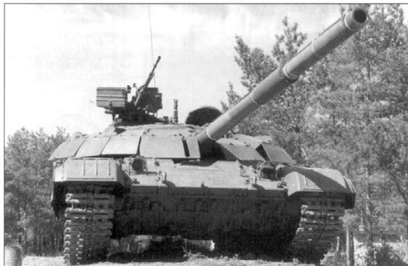
Т-64У - модернизация ХКБМ танка Т-64Б, испытания в Чугуеве. Фото из коллекции А. Ильина. T-64Y tank (T-64B tank modernization) tests in Chuguev.
