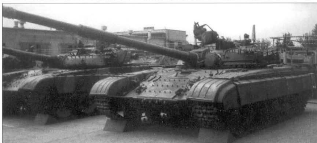
Танк Т-64Б-1. На башне танка отсутствует надбой. Фото В.Петрусенко. T-64B-1 tank. There is no auxiliary armor on the tank turret.
