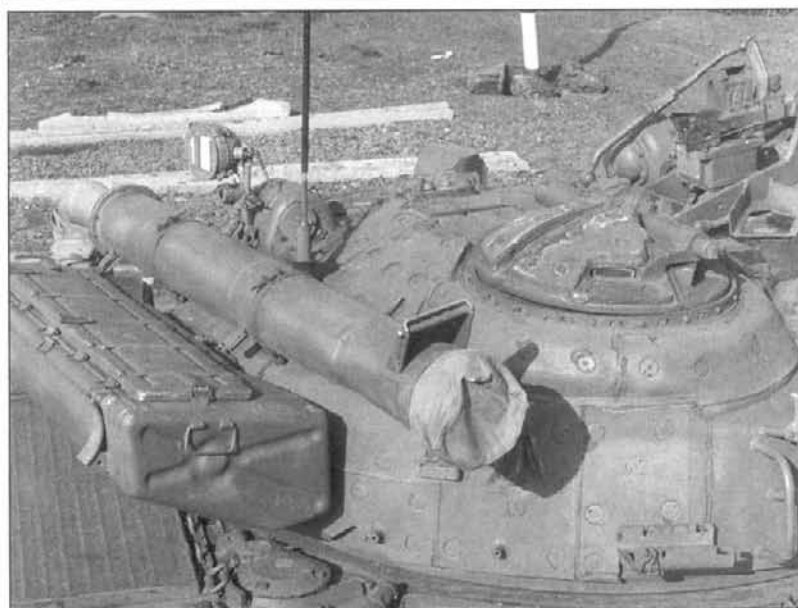
Танк Т-64Б. Обратите внимание на установку дымовых гранатометов и размещение опознавательного знака "Збройних Сил України". T-64B tank. Notice the smoke grenade-gun mounting and placement of "Ukraine armored forces" sign.
