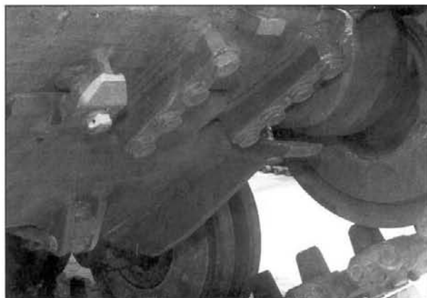
Крепление оборудования для самоокапывания на нижнем наклонном лобовом листе. Видны направляющее колесо и 1-й опорный каток и место крепления минного трала КМТ-6. T-64 tank, the bottom hull.
