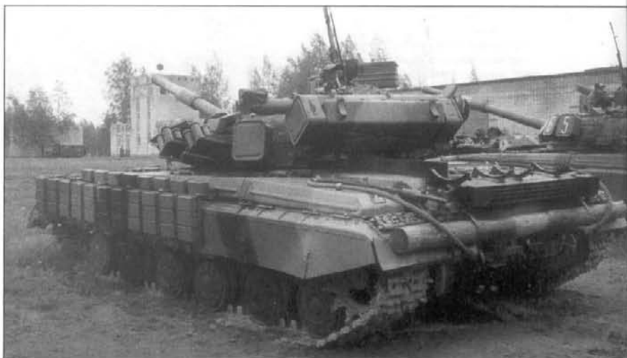
Т-64А с минным тралом КМТ-6. Сертолово, День Танкиста, сентябрь 2000 г. Фото С.Ковалева. T-64A tank with a KMT-6 mine-sweeper. Sertolovo. Tanker Day, September 2000.
