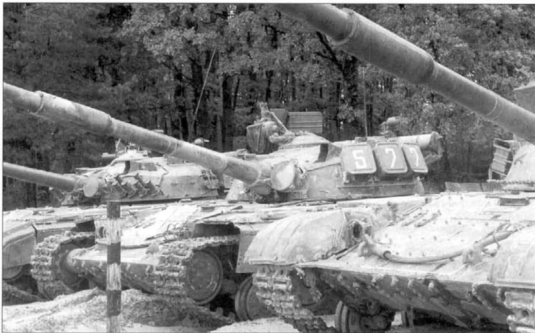
Танк Т-64А выпуска 1976 г. после капремонта на танкодроме. Подкрылки "снесены" в результате неудачного вождения. 5 тп, уч. центр "Десна", июль 2000 г.
