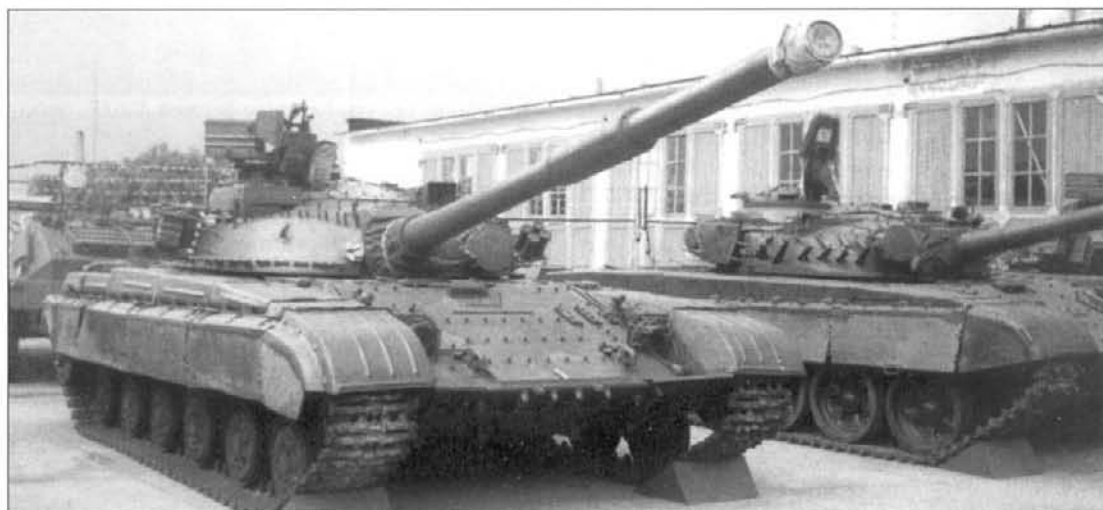
Танк Т-64Б после капитального ремонта доведенный до уровня Т-64БВ. Динамическая защита снята. Парк КИСВ (КВТИУ) в Киеве. Фото М.Саенко. T-64B tank after major repair is similar to T-64BV tank. Dynamical protection is dismounted. Ground Forces Kiev Institute (GFKI) park in Kiev.
