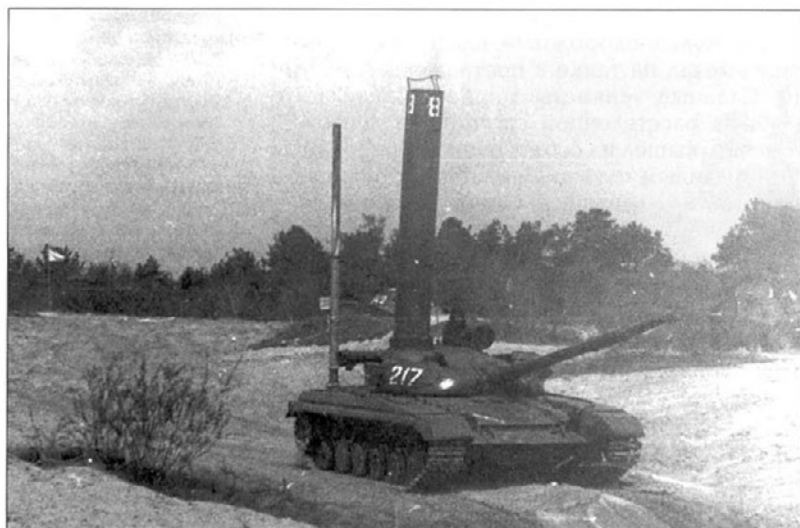
Т-64-А с установленным ОПВТ. Подводное вождение в пос. Гореничи, КВТИУ, 1979 г. Фото М. Чобитка. T-64A tank with mounted air supply pipe. Underwater driving in Gorenichi village. High Tank Engineering School in Kiev.
