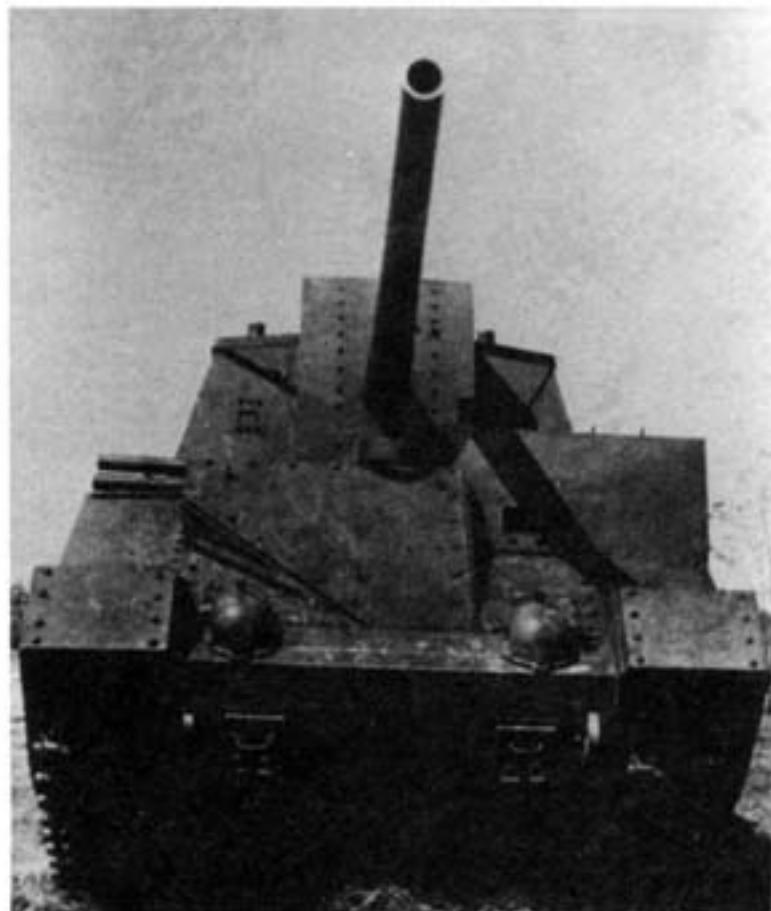
Забронированная СУ-14 с пушкой У-30 во время испытаний в Киевском Особом военном округе. Июль 1940 года
